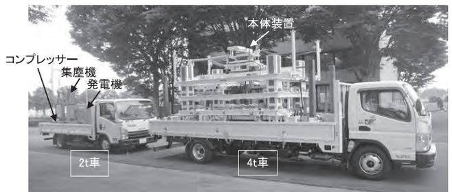
写真—2 研掃装置（道路トンネル適用時）
