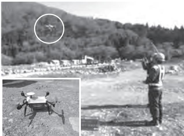
写真一 1 UAV による 3 次元測量
