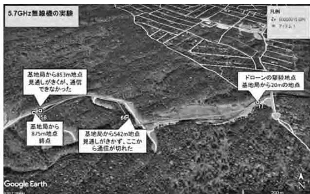
図-5 地表付近でのドローンの通信可能距離 (DLB5-R)
