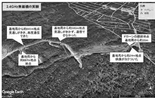
図-4 地表付近でのドローンの通信可能距離 (DLB2-R)
