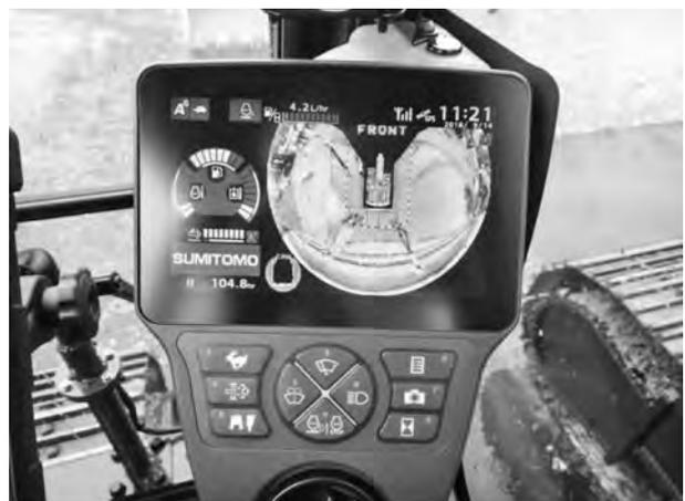
写真-3 カメラの合成映像
