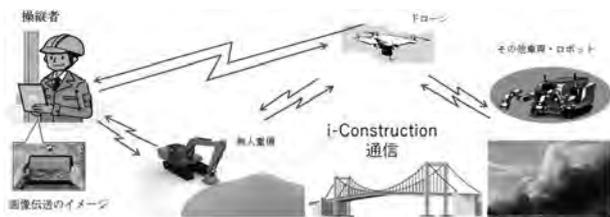
図—1 i-Construction での機器間連携
