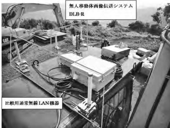
図-8 ロッククライミングマシン上の無線機
