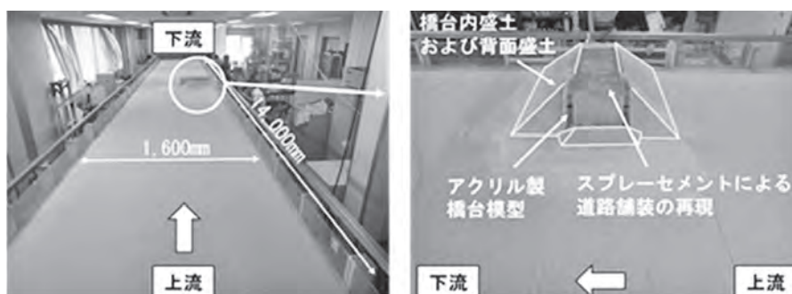
図-5 実験開始前の開水路の状況
