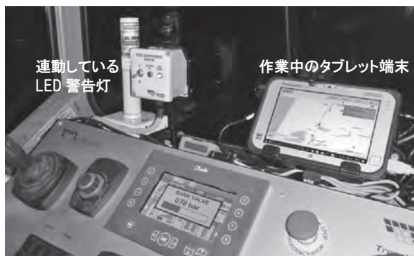
写真1 タブレット端末の重機運転席への設置状況
