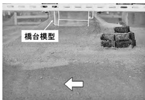
図—20 実験③における模型対策工の状況
