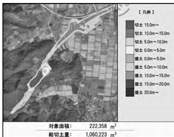
図一 8 工事着手前の UAV による 3 次元写真測量結果
