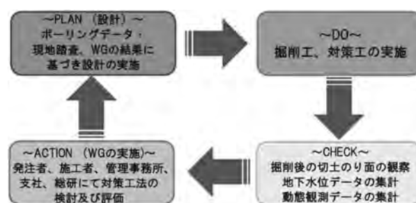
図一3 施工・検討のサイクル
