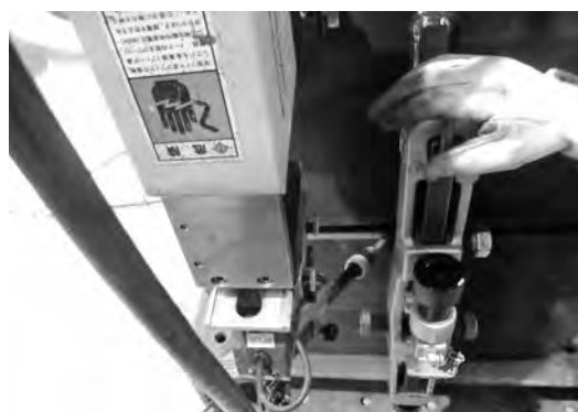
写真一 2 仮固定治具の回避溶接機構
