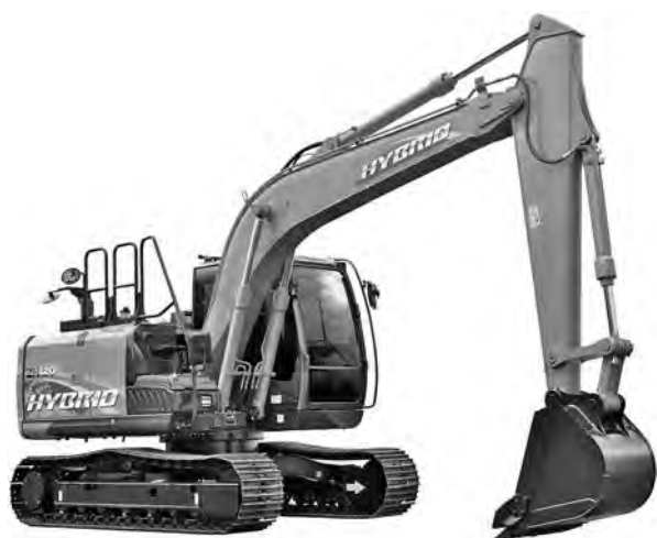
写真—2 日立建機 ZH120-6 ハイブリッド油圧ショベル
