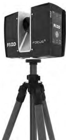
図—1 3D レーザースキャナ（FARO 社 Focus S350）
