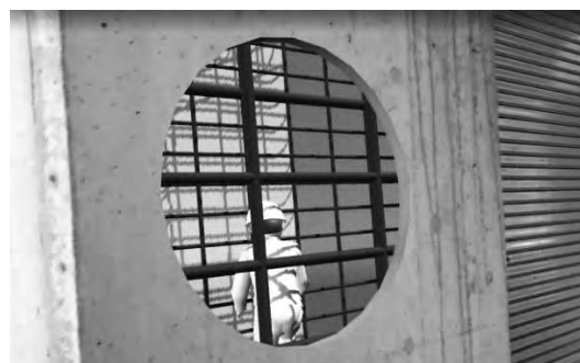
写真ー12 鉄筋探索結果をモデル化しARで表現
