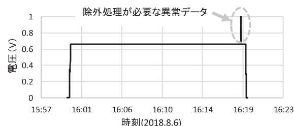
図-14 エンジン回転計の異常データの例
