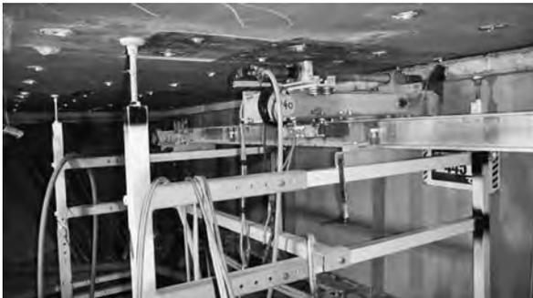
写真-5 WJ 装置及びレール架台装置
