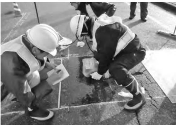
写真一八 超音波計測
