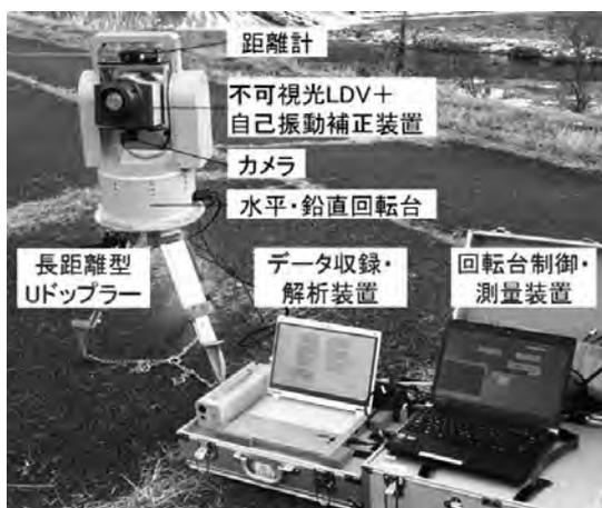
写真一1 長距離型Uドップラーシステム
