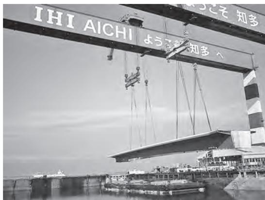
写真一 ゴライアスクレーンによる浜出し
