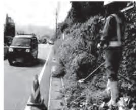
「国立研究開発法人・農研機構」が従来刃との飛散比較試験を実施
