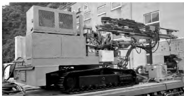
写真－2 小型クローラ搭載型スロット削孔機全景
