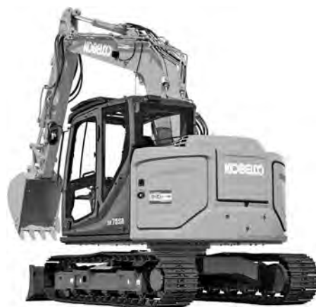
写真一 コベルコ SK75SR-7 油圧ショベル（後方超小旋回型）
