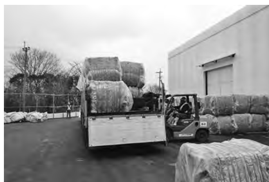
写真-3 破砕後の畳の圧縮梱包物
