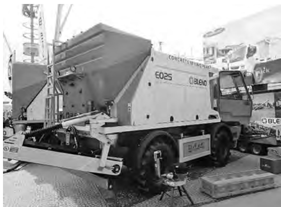
写真-18 移動式練混ぜプラント (BLEND)
