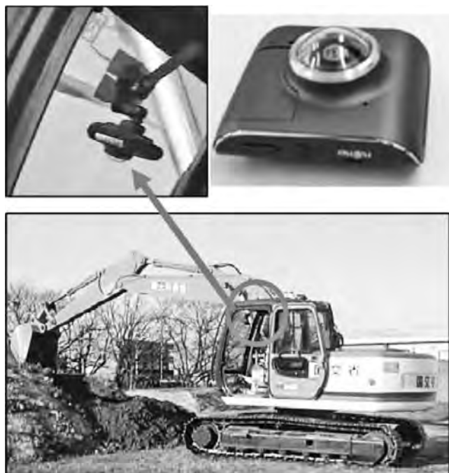
写真—15 360°カメラを用いた遠隔操縦 同時に全方位の動画を高画質で伝送可能。AIを搭載しており、人間の接近などを検知可能。
