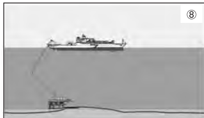
図一3 故障修理手順2 (ケーブル捕線～故障点除去)
