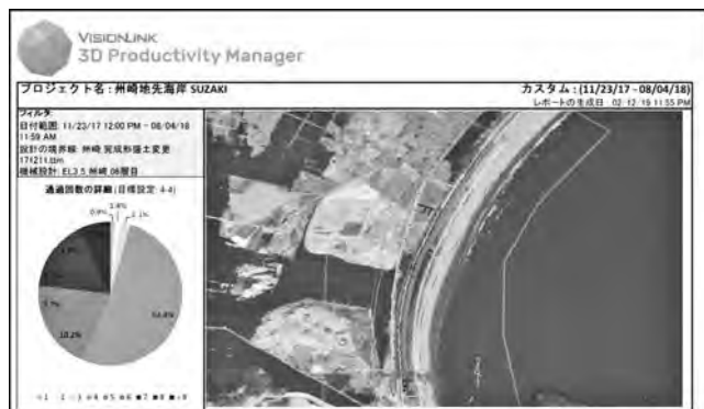
図—3 転圧回数表示状況
