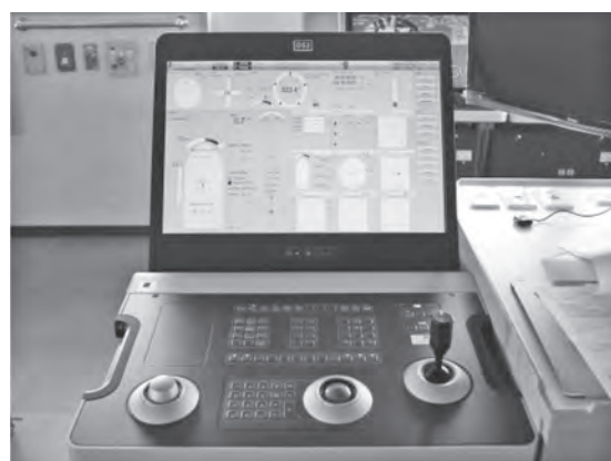
写真—10 DPS 操作盤
