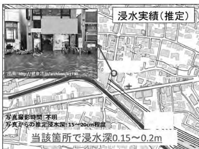
図—6 浸水状況写真からの浸水深判読結果 (2018.8.13)
