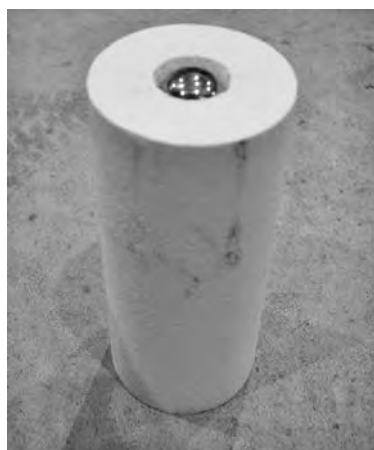
図-2 飛翔体（銅球）が埋め込まれたサボの外観
