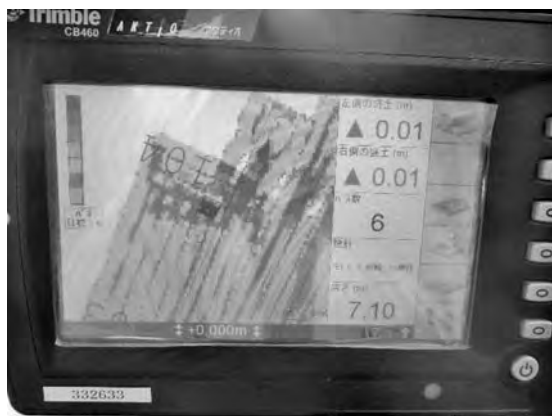
写真—3 転圧回数表示状況
