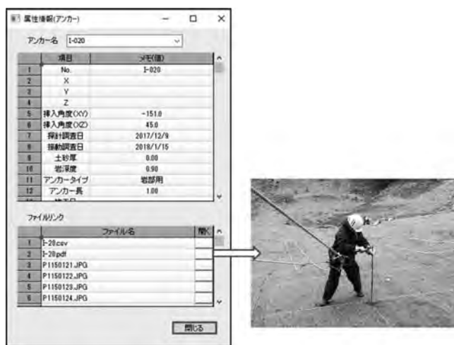
図—4 属性情報および施工写真表示例
