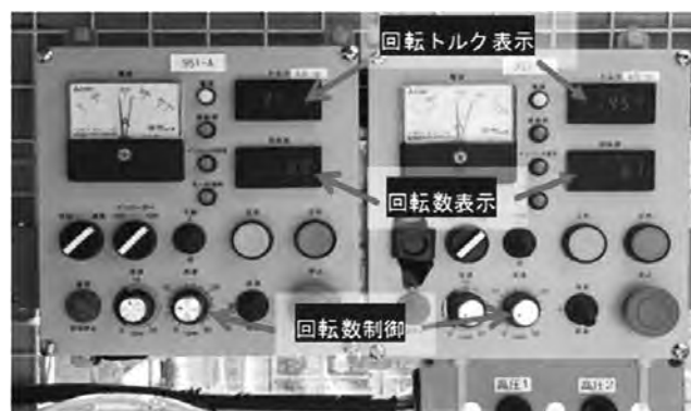
写真一 3 インバータモータによる回転数制御
