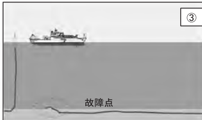
図—2 故障修理手順 1 (ケーブル探線)
