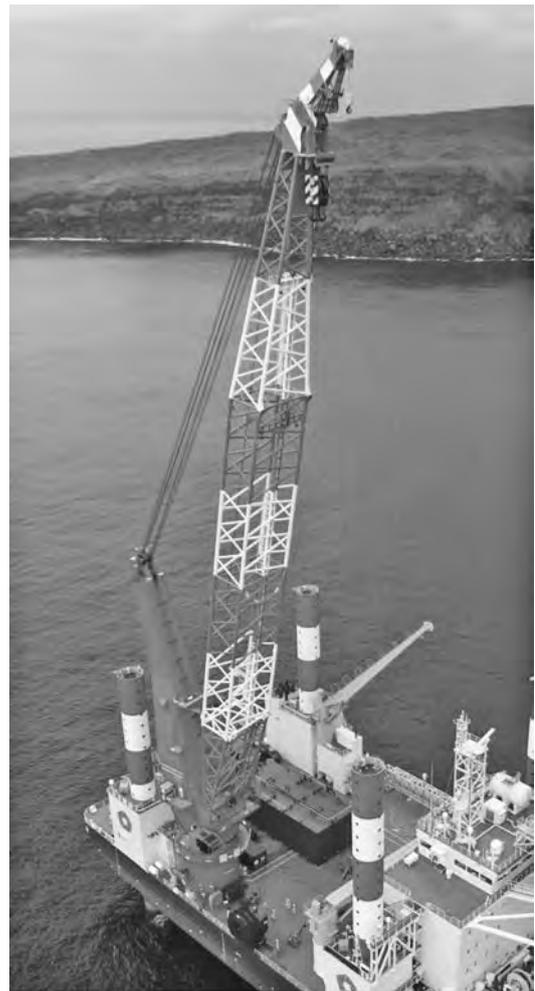
写真-3 800t吊全旋回クレーン
