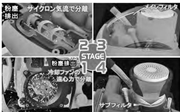
写真一四 「4ステージエアクリーナシステム」の構造図
