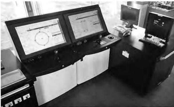
写真—6 自動船位保持装置 操作盤
