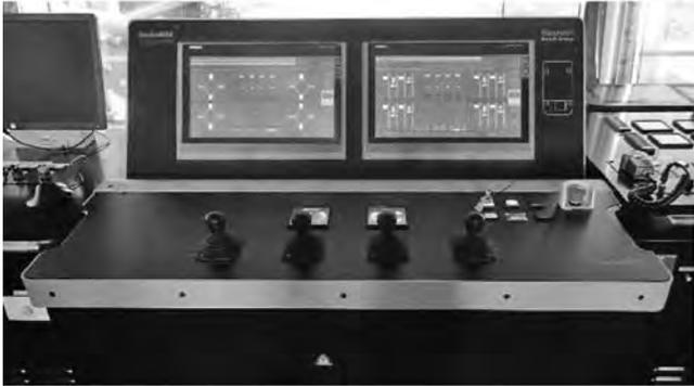
写真-2 ジャッキ装置 操作盤
