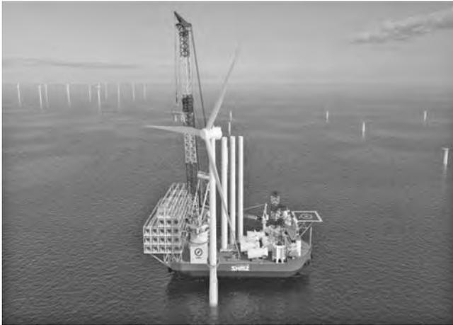
写真—9 世界最大級の搭載能力およびクレーン能力を備えた自航式 SEP 船
