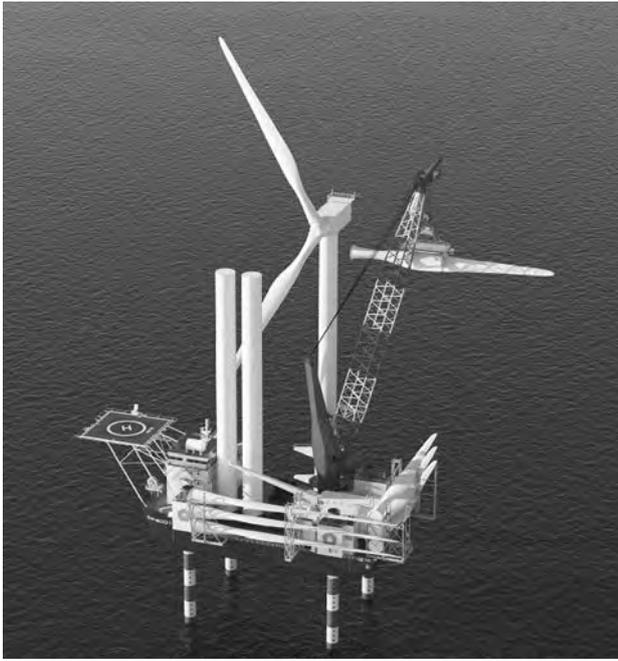
写真-13 風車設置イメージ
