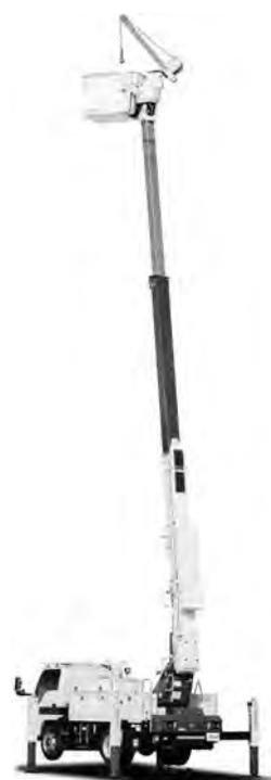
写真一五 アイチコーポレーション スカイマスターSH15C1FS トラック式高所作業車
