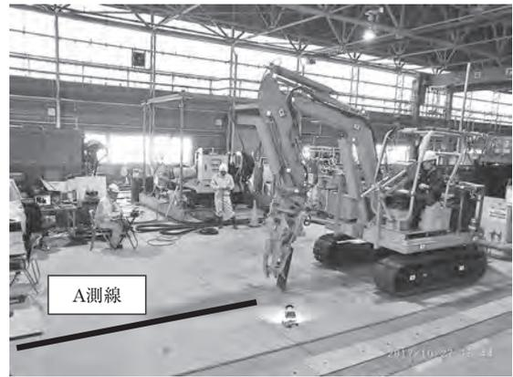
図一9 刃先座標精度試験状況
