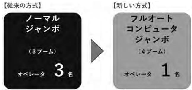
図一八 施工人員削減モデル
