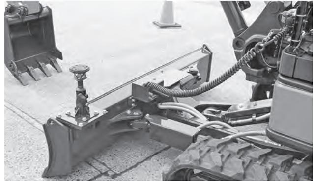
図一5 計測器類の搭載状況（ターゲットと傾斜角センサ）
