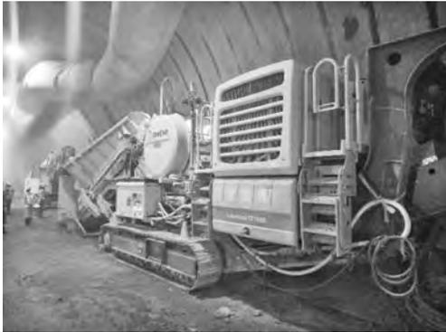
写真一四 海外製クラッシャ（metso製）
