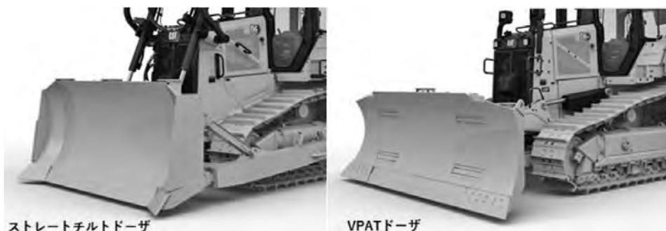
図一2 作業装置の種類
