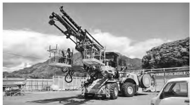
写真—3 鹿島 Robodrill P612 ロックボルト打設専用機
