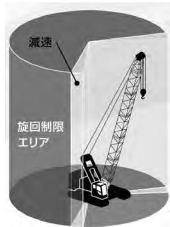
図-6 旋回角度制限装置
