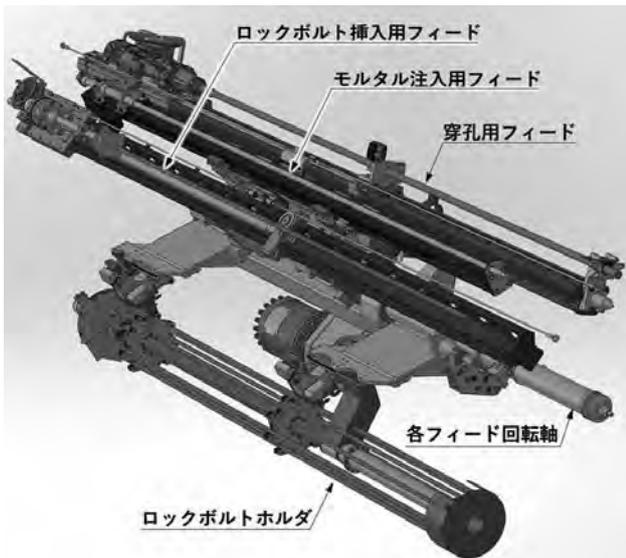
図一 1 Robodrill P612 ロックボルト打設専用ブーム
