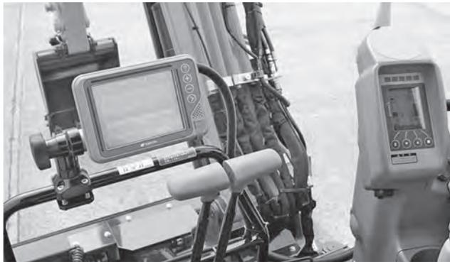
図一4 計測器類の搭載状況（モニター）
