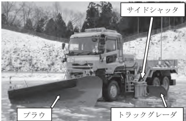
写真-1 除雪トラックの主な作業装置
