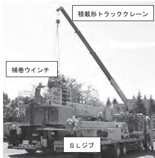
写真一九 SLジブ運搬および補巻ウインチ組立状態
