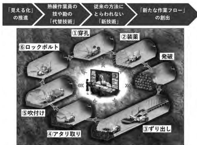
図—9 新たな施工方法例（山岳トンネル）
