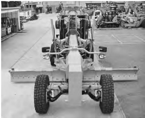
写真一3 試作中のバリエブルブレード
