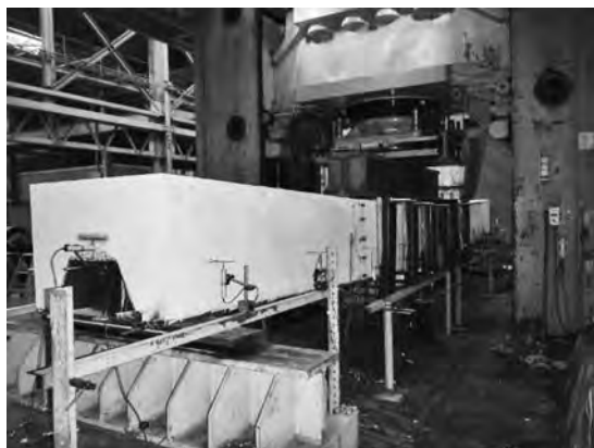
写真—4 梁曲げ試験状況
