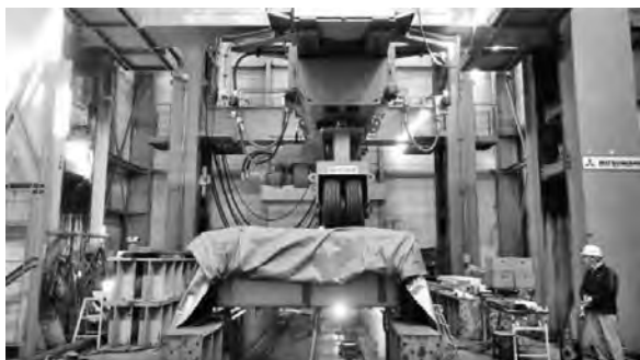
写真一 3 輪荷重走行試験の外観
