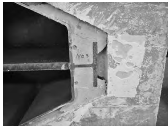
写真 2 押抜き試験の破壊モード
