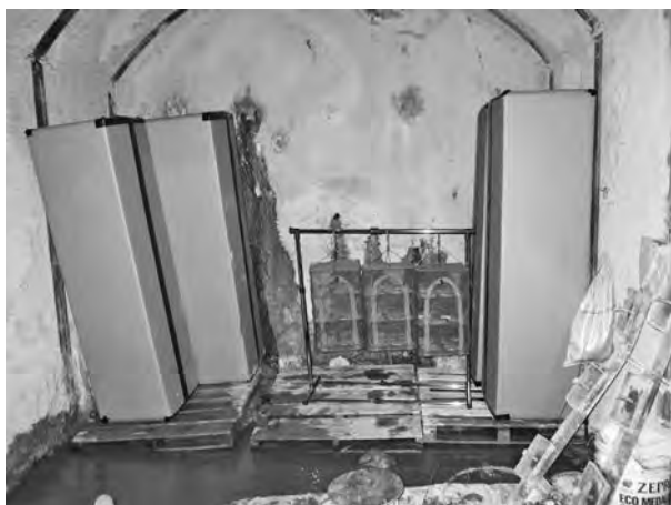
写真—3 箱状試験体と耐候性試験の状況
