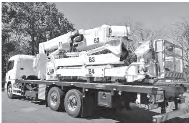
写真—1 日本ロード・メンテナンス ロードマルチ点検車
