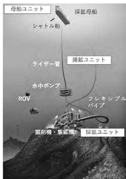
図—1 採鉱・揚鉱システムの概念図の例
