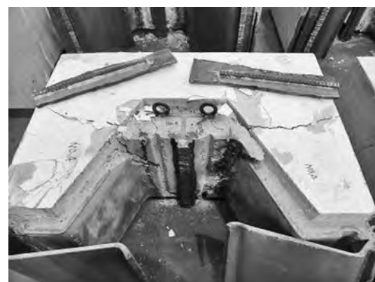
写真 3 ケース 4 の破壊モード
