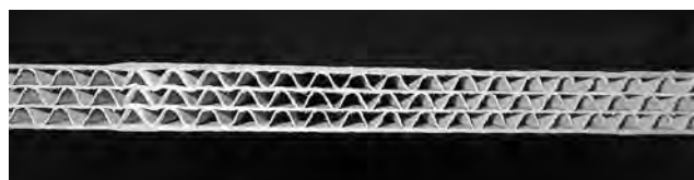
写真—1 3層構造の紙素材（厚さ 15 mm）
