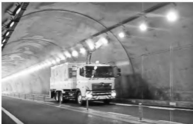
写真—3 トンネル灯具清掃車
