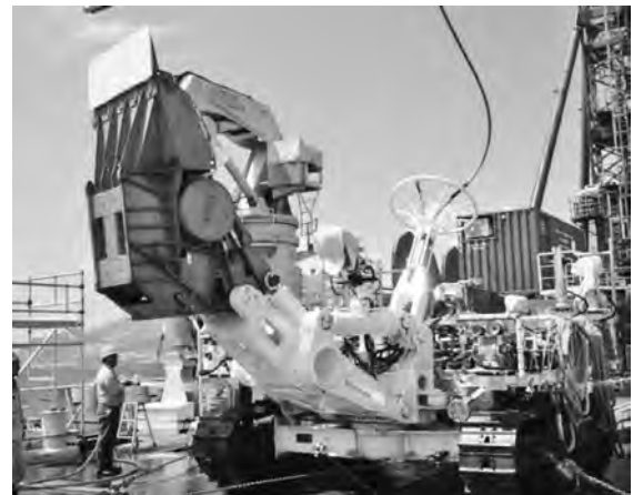
写真—3 試験機 B（破碎ヘッド）
