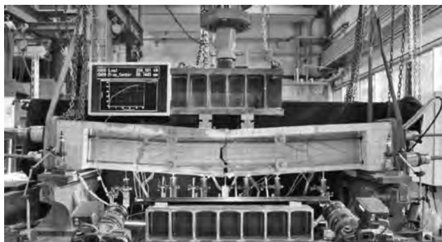
写真—1 鋼繊維補強 PFC を用いた外ケーブル方式 PC 梁の荷重試験
