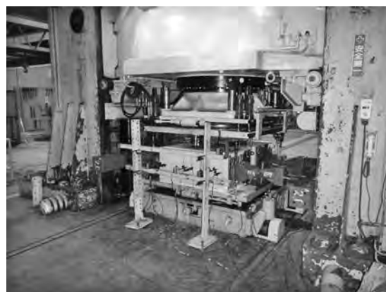
写真一 押抜き試験状況
