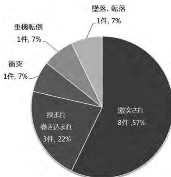
図—1 締固め機械の事故の型の割合
