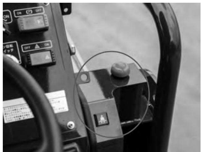
写真-4 解除スイッチとシートベルトリマインダのインジケータ
