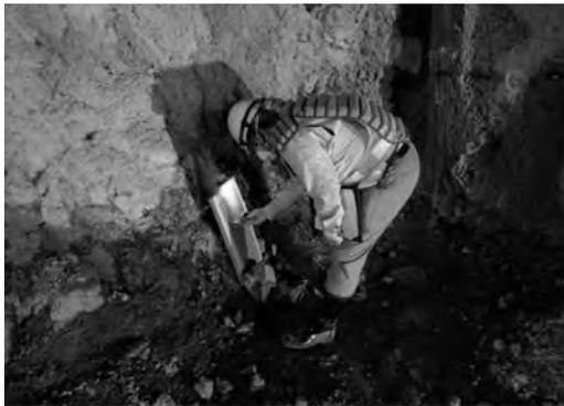
写真一3 クリノメーターによる測定 (ウレタンボード)
