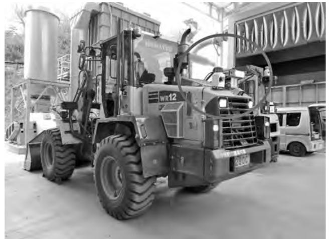
写真-6 磁界発生装置と外部警告発報装置を取り付けたホイールローダ
