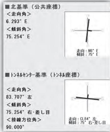
図一4 タブレット上に表示される走向・傾斜の表示例
