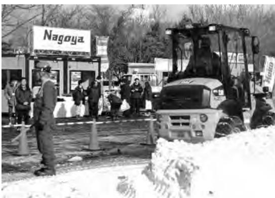
写真-28 (株)カナモト タイヤショベル 接触防止センサー付
