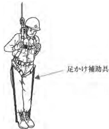
図-2 足掛け補助具による自己延命措置
