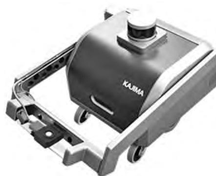
写真—1 鹿島建設 自動照度測定・調整ロボット
