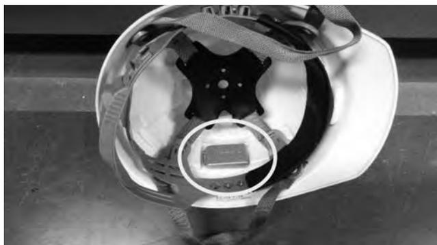
写真-1 ヘルメットの内側に取り付けられたICタグ
