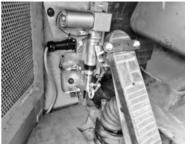
写真一 電動シリンダ取り付け状況
