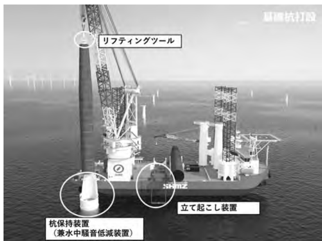
図-9 SEP 船上の機装システム
