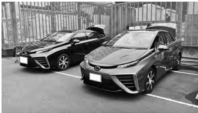
写真—2 建物に電力を供給するFCV (車両提供：神奈川トヨタ自動車株)
