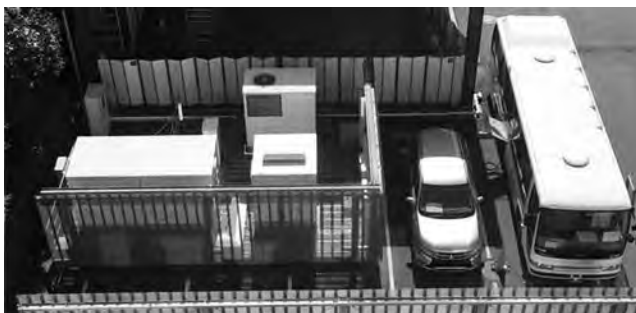
写真-1 72時間連続自立給電実証に用いたPHEV (東京電力エナジーパートナー(株)との共同実証)
