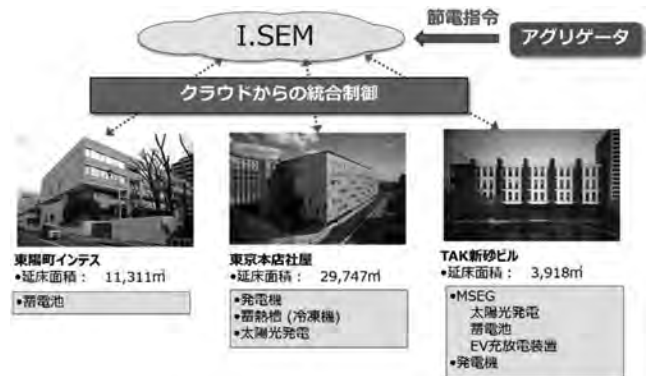
図一3 VPP 機能を実装した3棟の概要と制御対象設備
