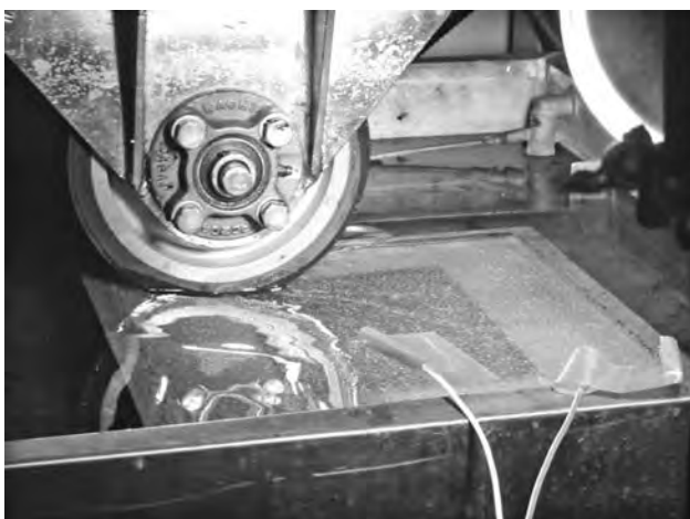
写真一2 発電させながらの室内評価試験の例 (大型車輪荷重相当+水浸+60℃)
