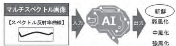
図一9 AIによる風化度評価の概要
