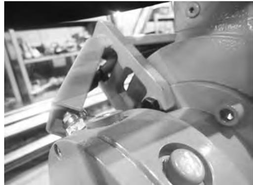
写真一2 ロールオーバーセンサの補強
