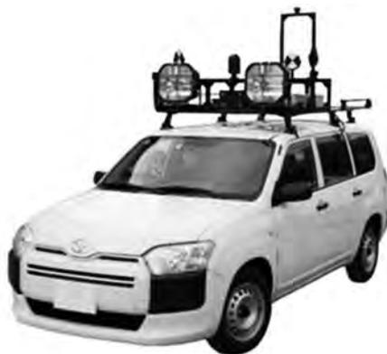
写真-1 データ取得用の専用車両
