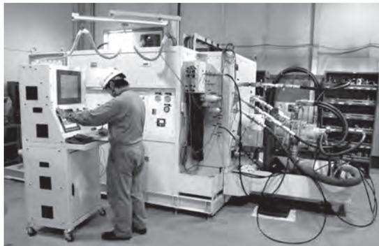
MH-R220は従来の油圧ドライブ型油圧機器試験機に比べ、インバータ制御電動モーター駆動、及びエネルギー回生回路の採用により大幅な消費電力量の削減を実現しました。大型油圧ポンプの試験も可能です。
