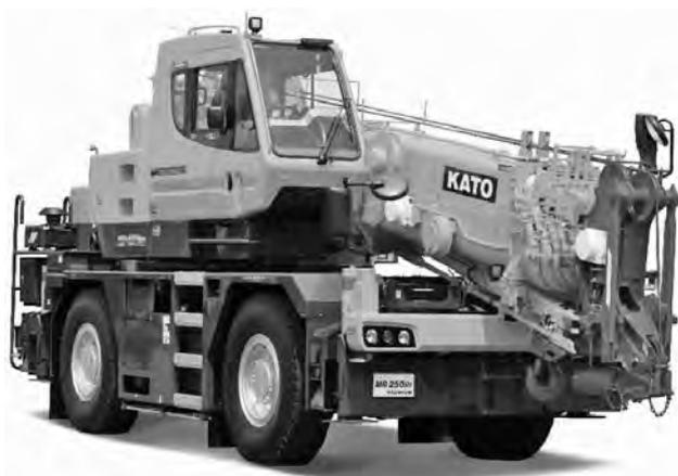
写真一 加藤製作所 MR-250Rf PREMIUM ラフテレーンクレーン (伸縮ブーム形)
