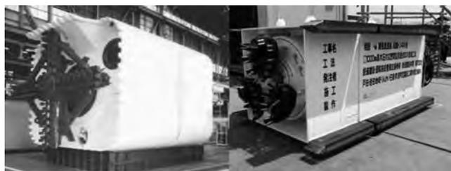
図一10 (左) コピーカッター方式・(右) 多軸自転公転方式
