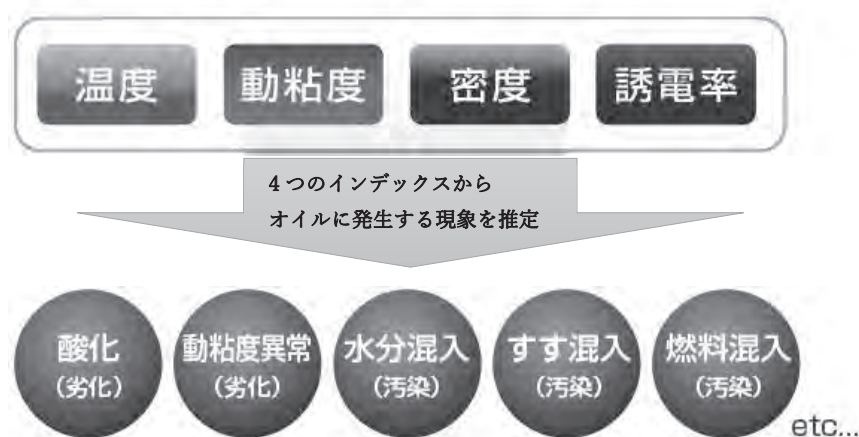
図ー6 イメージ：4つのインデックスからオイルに発生する現象を推定
