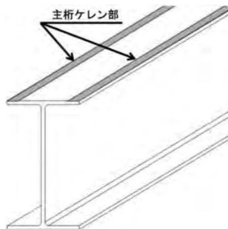
図—4 主桁ケレン部
