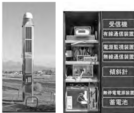
写真—1 電子基準点の形状と内部の機器
