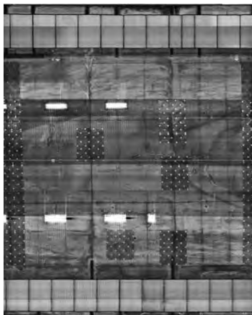
写真一3 ラインカメラ画像の自動貼り合せ
