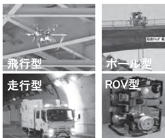
図—2 インフラ点検用ロボットの例
