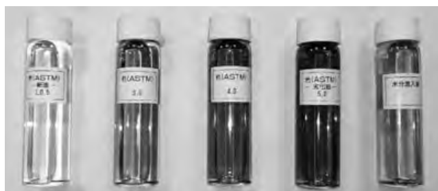
写真—1 ASTM D1500にて評価した作動油の新油、劣化油、水分による汚染油の比較 左から新油 (L0.5)、安全領域の使用油 (3.0)、注意領域 (4.0)、更油領域 (5.0)、水分混入油
