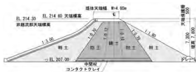
図一八 新設堤体断面のゾーニング
