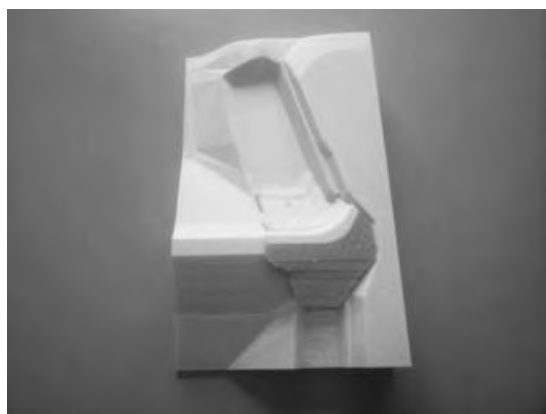
写真—17 新設堤体モデル
