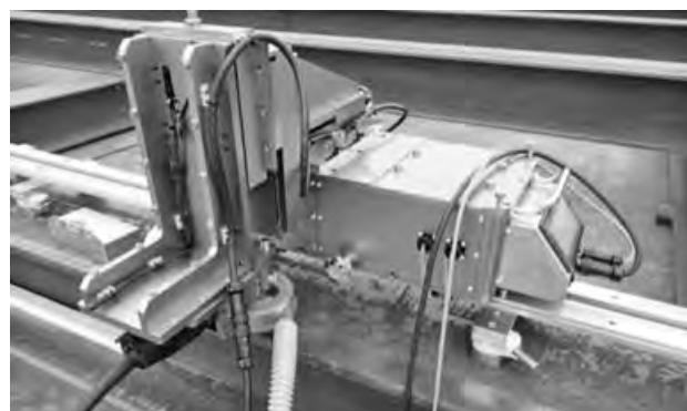
写真—5 自動ケレンロボット
