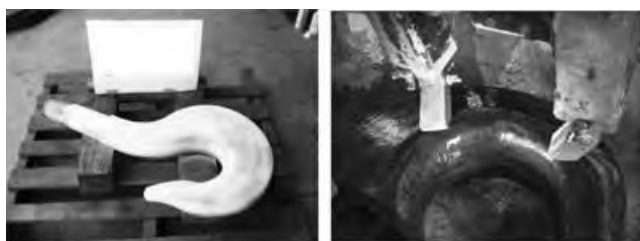
写真-5 フック分解検査
