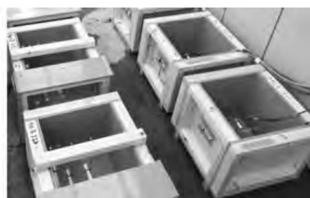
ひずみ計測用 (打設前型枠 30 cm 角)
