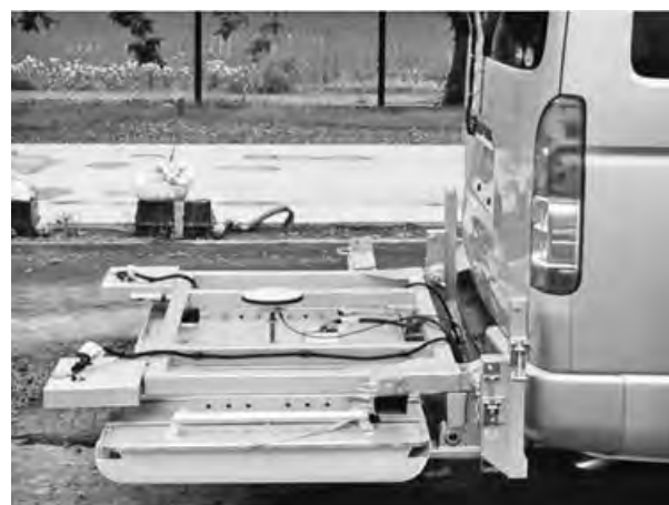
写真—1 地中レーダ探査機
