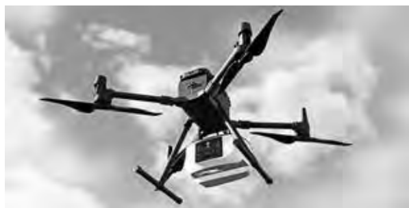
図—2 グリーンレーザー用スキャナーの搭載事例 (株)アミューズワンセルフ製 TDOT)
