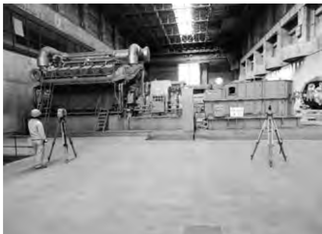
写真-1 高精度3次元レーザスキャナを用いた床版変状計測技術（新技術情報提供システムより）
