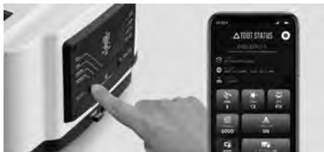
図—5 スキャナー操作の説明とスマートフォンを用いた測量中のステータス確認画面例
