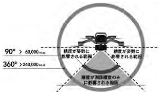
図-4 測量誤差とレーザースキャン範囲の関係
