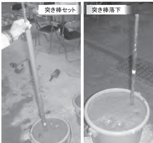
写真一1 N式貫入試験状況
