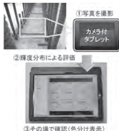
図-8 打継面の評価システム<sup>8)</sup>
