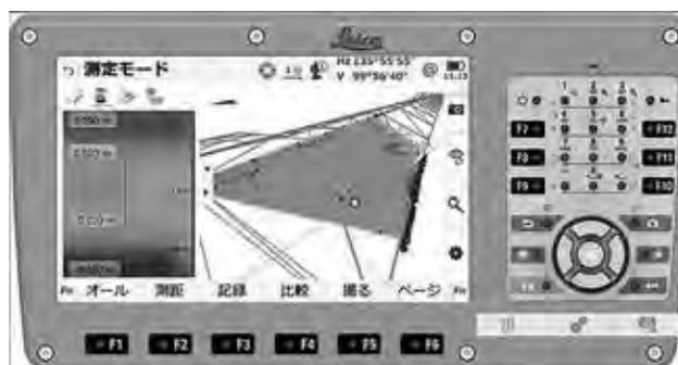
写真一4 出来形を計測して取得した点群データと3D設計データを面的(凹凸)に比較評価 (MS60の画面)
