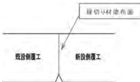
図一5 覆工コンクリート目地部分塗布面 (断面図)
