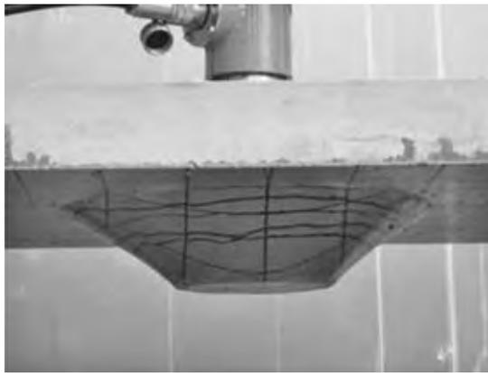
写真一2 変位 50 mm 時の試験体
