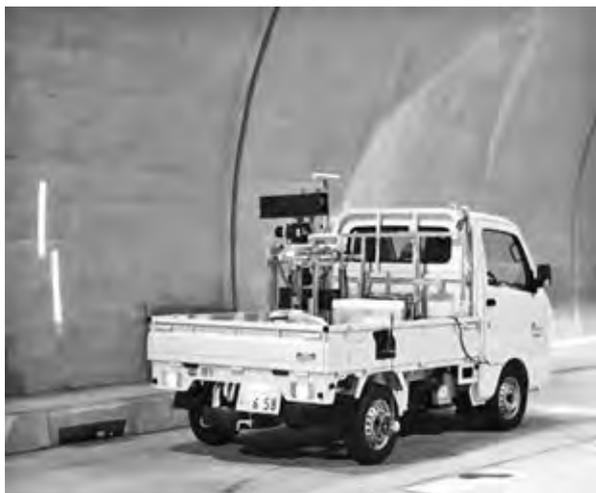
図一4 走行型レーザー表面計測装置
