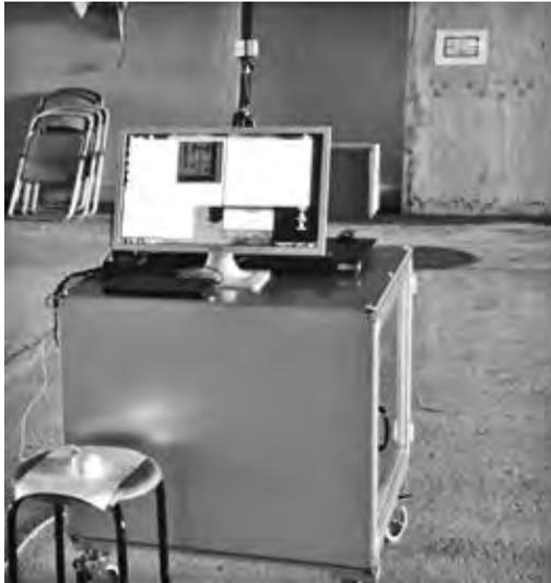
図一 高分解能レーザー表面計測計測器
