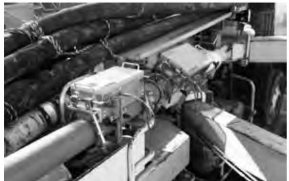
写真—1 連続 RI 計測に基づく単位水量測定システム<sup>5)</sup>
