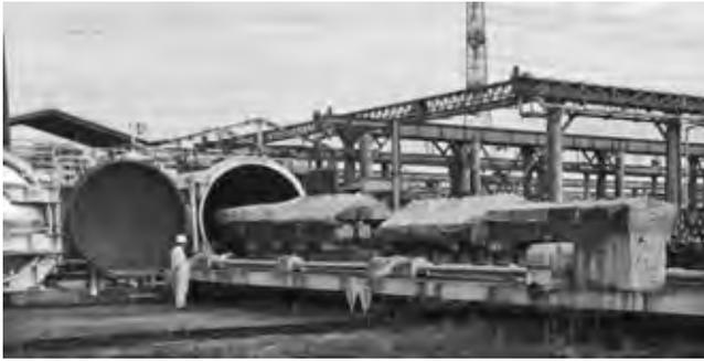
写真-1 オートクレーブ養生状況
