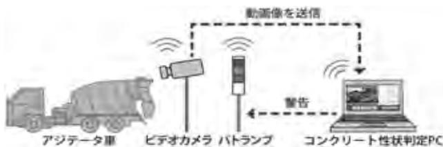
図—3 施工性判定システム<sup>4)</sup>
