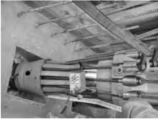
写真一2 変位計取付け状況（緊張側）
