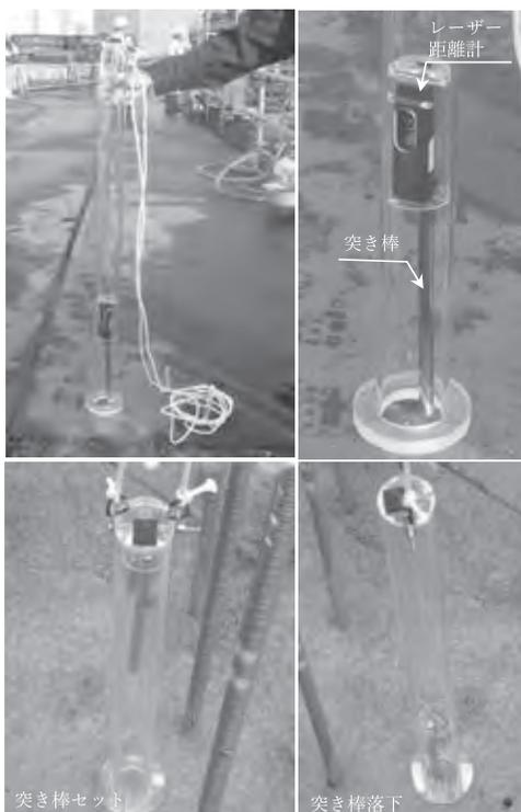
写真-2 N式凝結テスター使用状況
