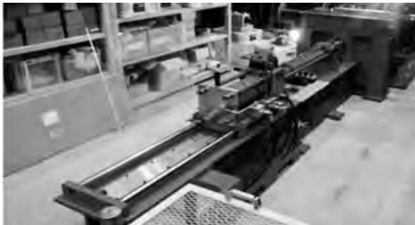
写真一 9 高速衝撃実験装置
