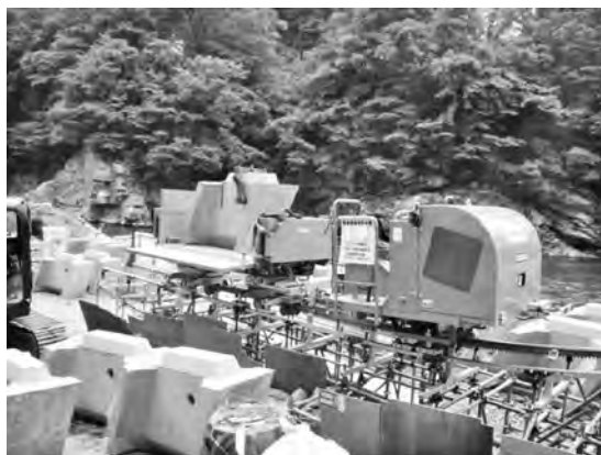
写真—17 大型ブロックを積込固定できるように改造
