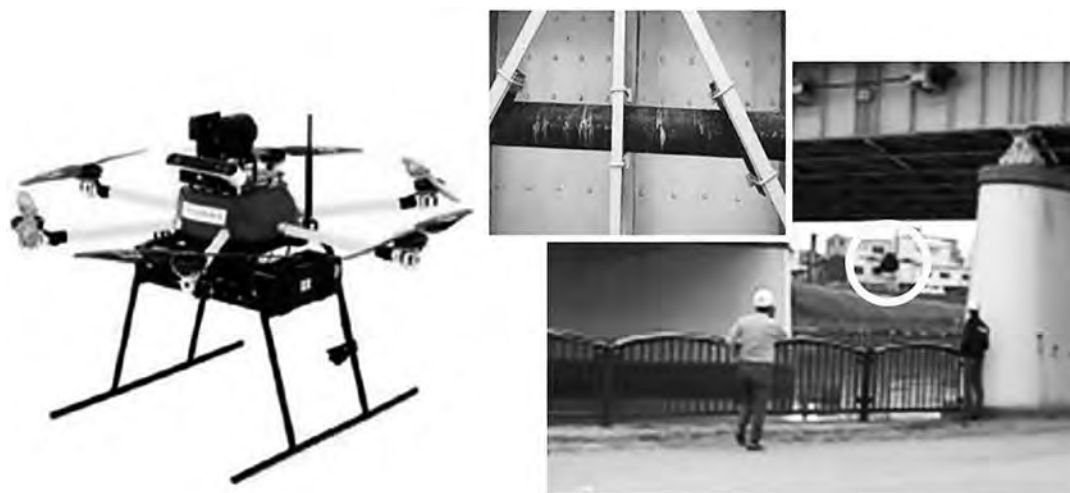
写真一4 非GPS飛行ドローン（開発途上タイプ）
