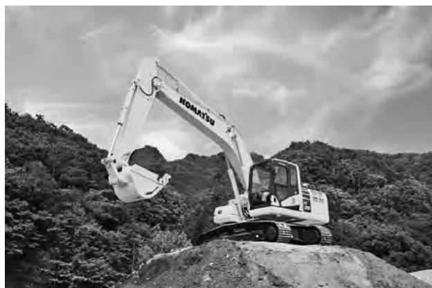
写真-8 KomVision 人検知衝突軽減システムを搭載した PC200-11
