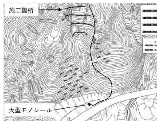
図—1 モノレール仮設図面
