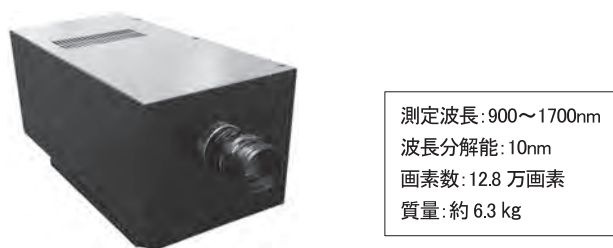
図—3 SIS-I型ハイパースペクトルカメラ（エバ・ジャパン製）の外観
