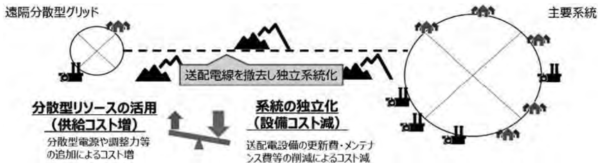
図一4 遠隔分散型グリッドの概要 4)
