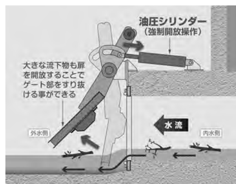
図一 8 強制開閉装置による挟雑物の除去
