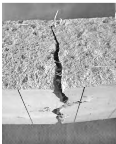
写真一 1 曲げ試験後の繊維補強モルタルの供試体片 (例)
