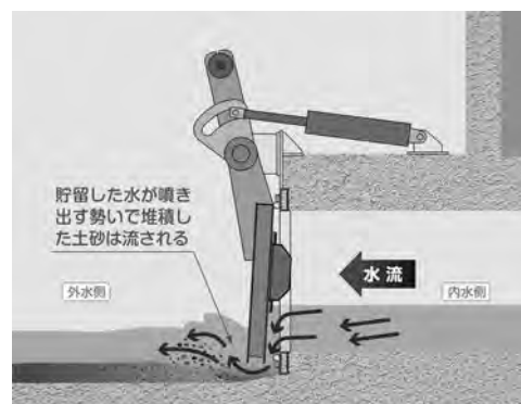
図一 9 強制開閉装置による堆積土砂のフラッシング
