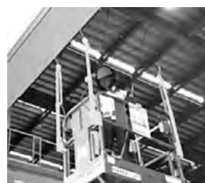
写真一 6 上部障害物検知センサー
