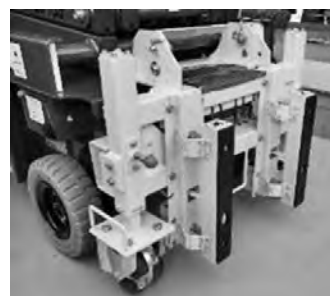
写真一 4 段差、障害物検知センサー
