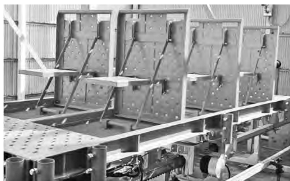
写真—21 大型モノレール用の乗用物流兼用台車
