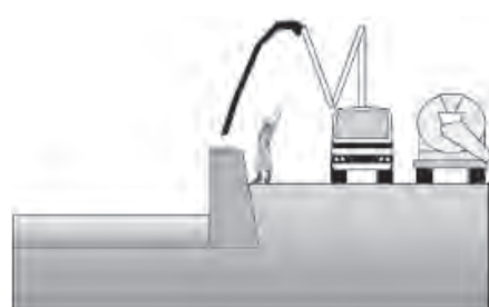
①目荒し、捨てコン打設
