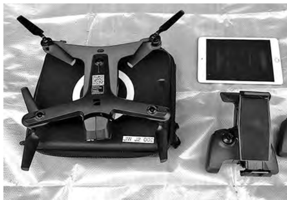
写真一5 小型施設点検用ドローン
