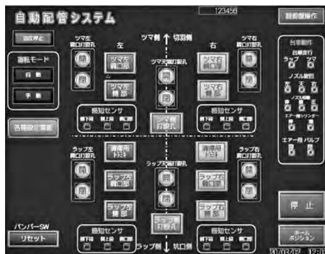
写真—2 タブレット操作画面例
