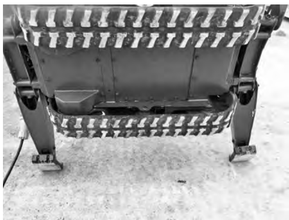
写真—5 横倒し状況での作動油漏れ未発生状況
