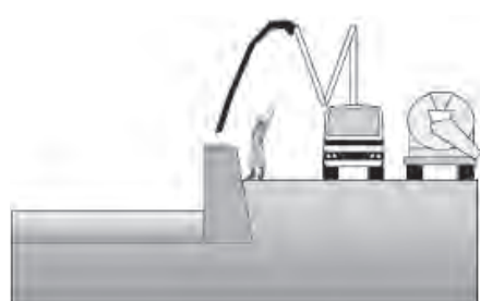
①目荒し、捨てコン打設
