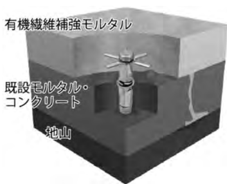
図—3 せん断ボルトの模式図
