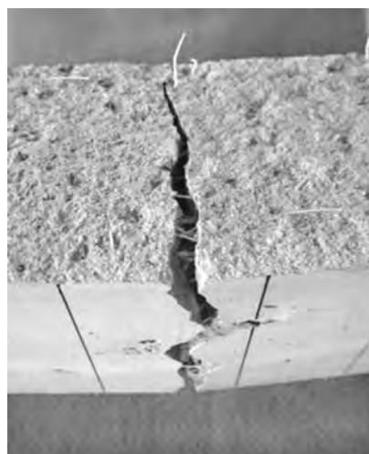
写真—1 曲げ試験後の繊維補強モルタルの供試体片（例）
