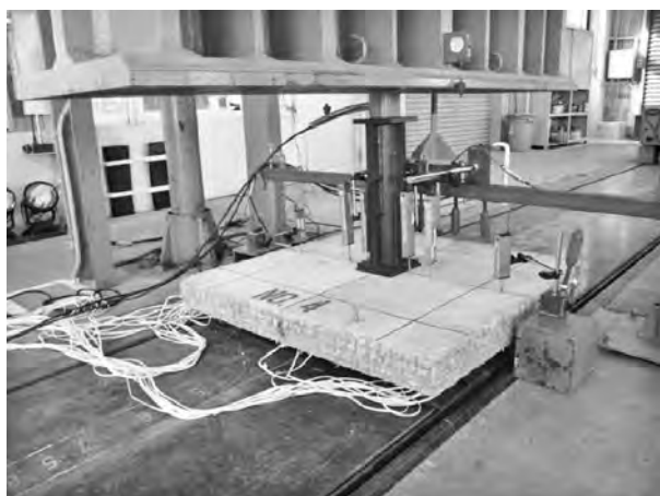
写真—5 FSC パネル耐力試験状況
