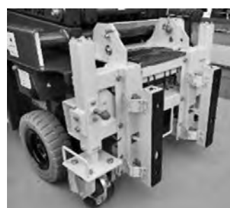
写真一 4 段差、障害物検知センサー
