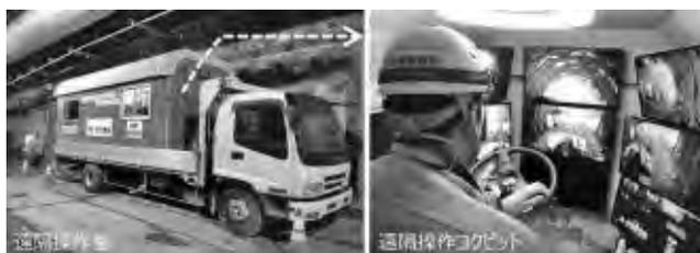
写真二 遠隔操作室および運転コックピット
