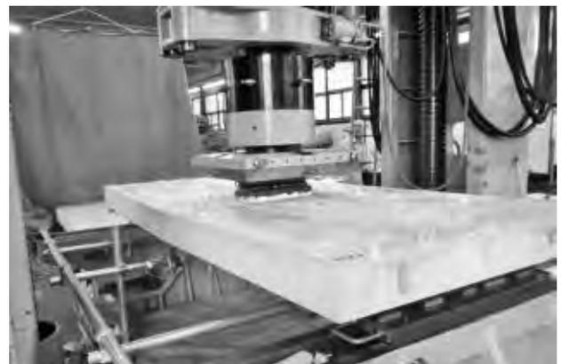
写真-2 静的曲げ試験状況
