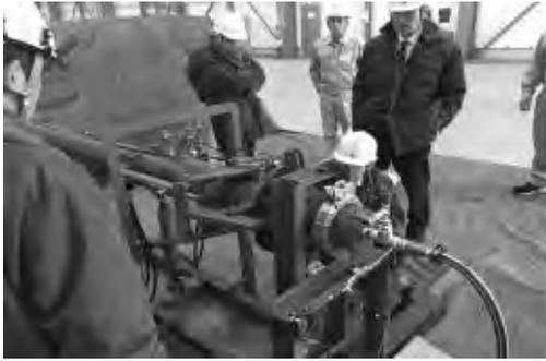
写真—16 モックアップ試験（接合機密）
