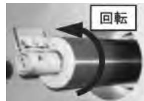
写真-2 チャンバー内土砂流動管理システム装置
