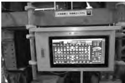
写真-12 打込み締固めモニター (展開)
