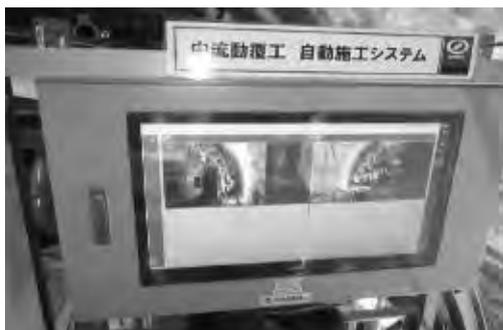
写真-13 自動施工システム制御盤
