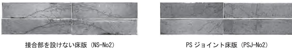
図一 10 試験体内部ひび割れ性状
