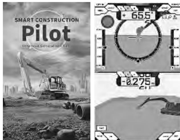
写真-9 スマートコンストラクション・レトロフィットキットアプリ「SMARTCONSTRUCTION Pilot」（アプリのデザインは変更される場合がある。）
