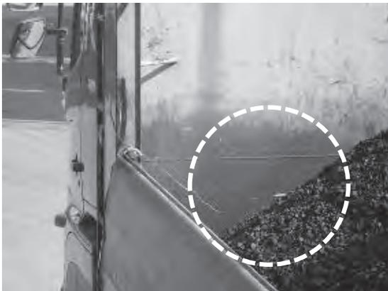
写真一6 運搬車熱電対設置状況
