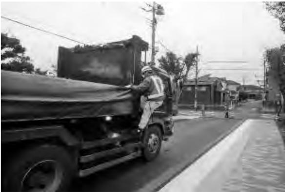
写真—1 運搬車への昇降
