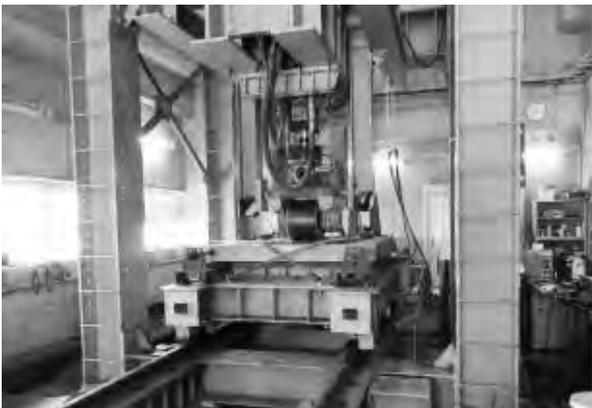
写真一三 輪荷重走行試験状況
