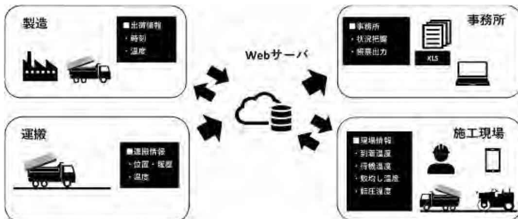
図—1 アスファルト舗装温度管理システムの流れ
