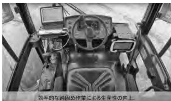
図-7 自律走行式ローラの運転状況
