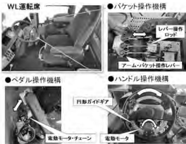
写真一 遠隔運転制御装置
