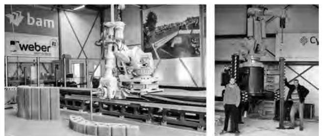
写真一 移動型3Dプリンタの事例 (左: BAM Infra & Weber Beamix<sup>9)</sup>, 右: CyBe Construction<sup>10)</sup>)
