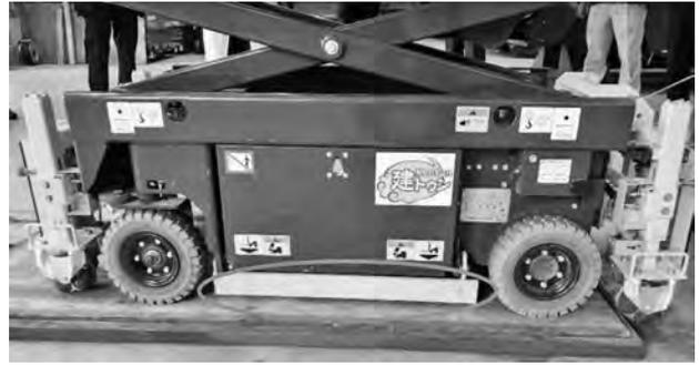
写真一4 安全装置ホットポールプロテクター展開状況
