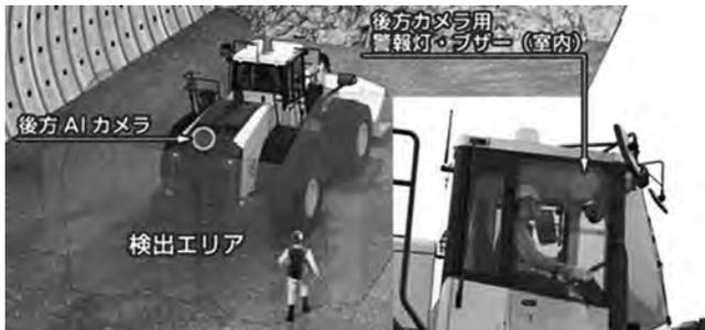
図-4 AI搭載カメラシステム
