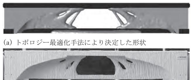
(a) トポロジー最適化手法により決定した形状
