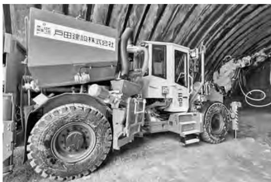
写真二 モルタル充填設備（施工時）
