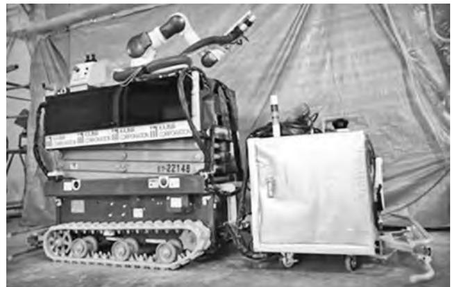
写真-1 耐火被覆吹付ロボット
