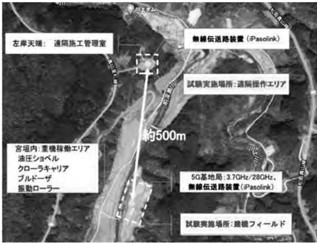
図-2 試験エリア配置
