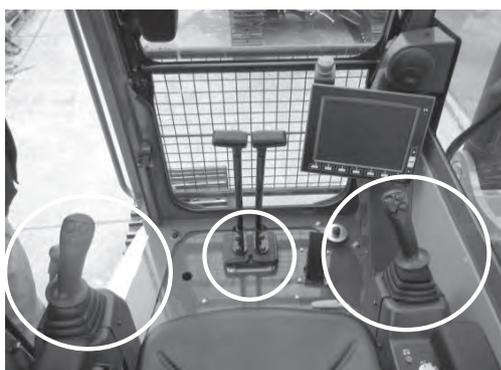
写真一 電気式操作レバー（丸印）
