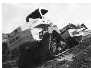
写真-64 斜面用クローラ型
