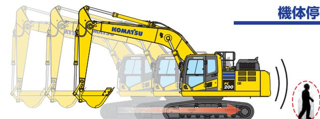
停止状態から走行するとき、また走行中(低速のみ)でも、停止制御エリアで人を検知すると走行を停止します。
