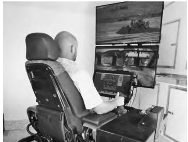
写真-2 Remote Operator Station の外観
