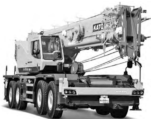
写真-1 大型ラフテレーンクレーン例 (80トン吊り)
