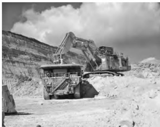
写真—1 超大型油圧ショベル・ダンプトラック
