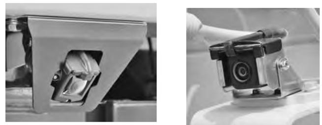
写真一3 カメラクリーナ取付例
