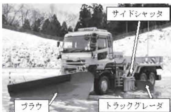
図一7 除雪トラックの主な作業装置
