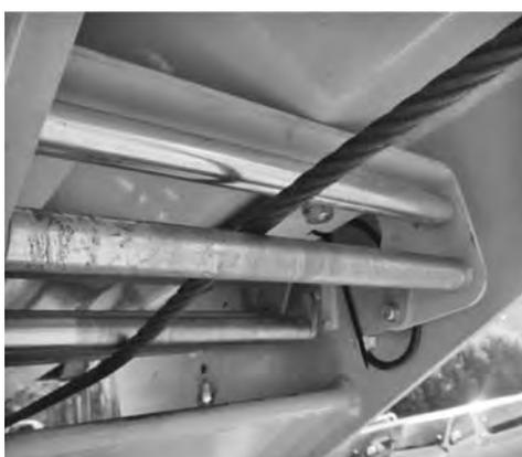
写真二 フック接地検出装置
