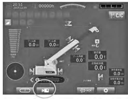
図—4 モニタ上のカメラスイッチ (丸印)
