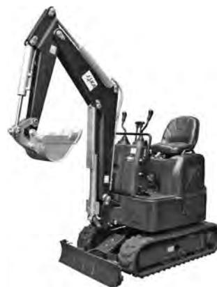
写真一七 複合材製軽量油圧ショベル
