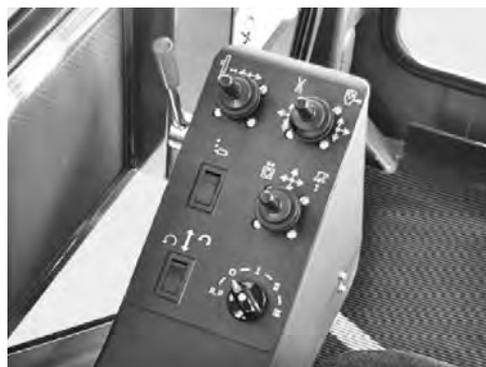
写真-4 ロッドチェンジャコントロールレバー
