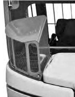
図-14 吸気口カバー (拡大図)
