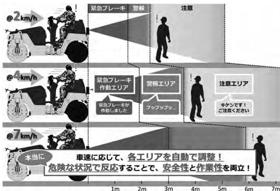
図-2 作業速度における緊急ブレーキの作動イメージ
