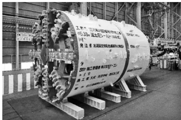
写真－4 シールド機全景
