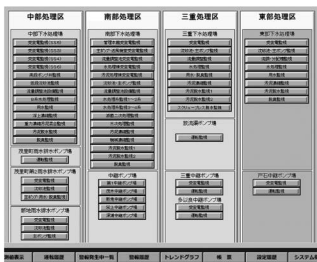
写真—1 下水道統合監視システムトップ画面
