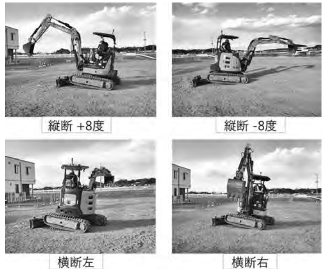
写真-3 車体傾斜時の計測状況
