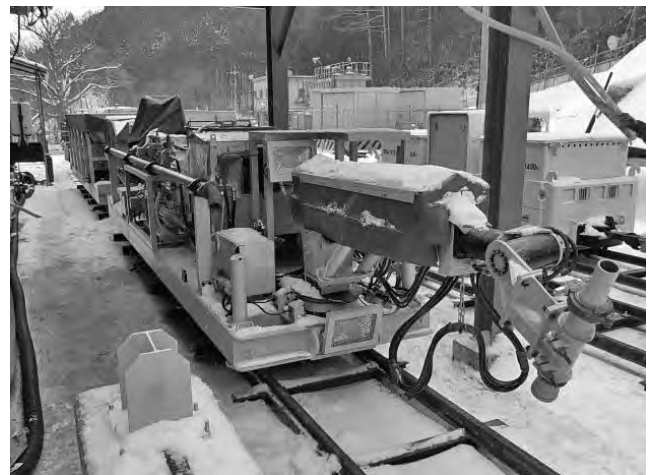
写真一〇 吹付ロボット台車
