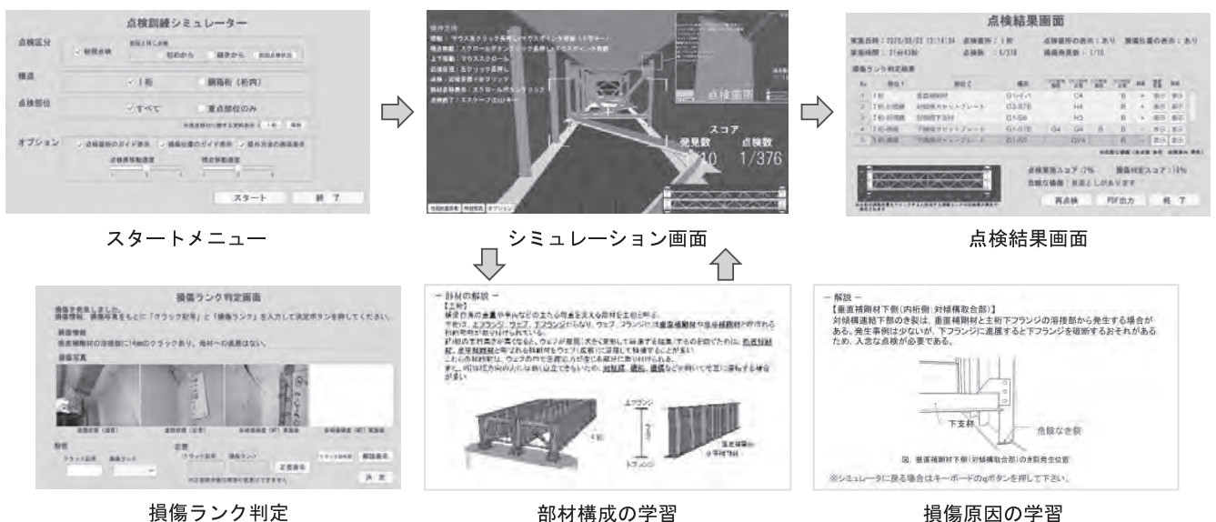
図-5 近接目視点検教育システムの主な機能
