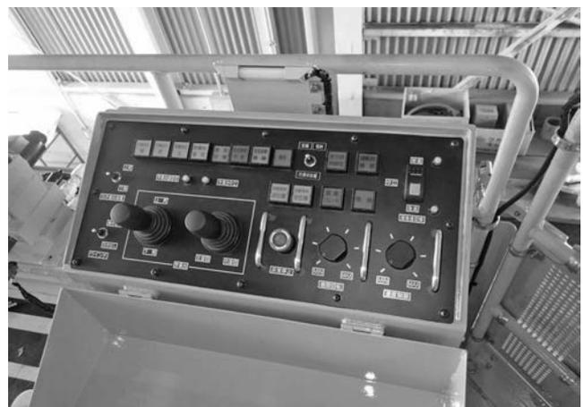
写真—6 作業台上, 簡易操作盤
