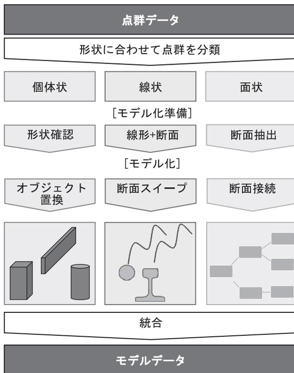
図-11 点群データ変換フロー図
