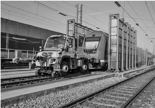
写真—4 ドイツ鉄道の車両牽引作業
