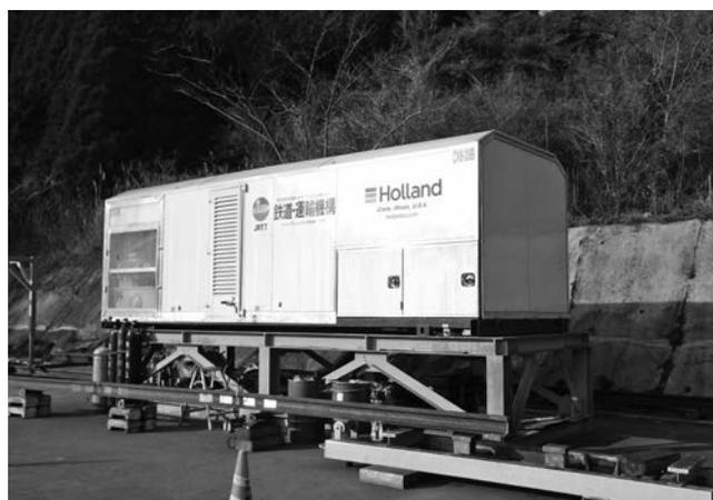
写真-3 溶接機格納状態
