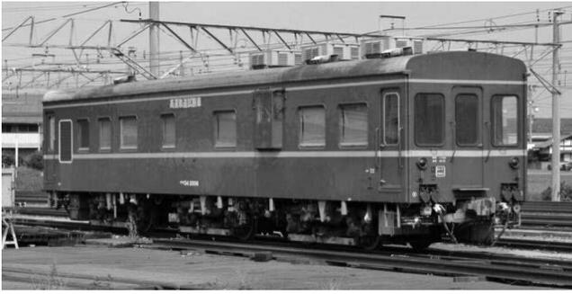
図-4 軌道検測車 (マヤ 34 形)
