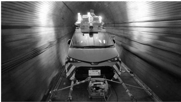
写真-2 伊豆急行線トンネル内を走行する移動計測車両「MMS」
