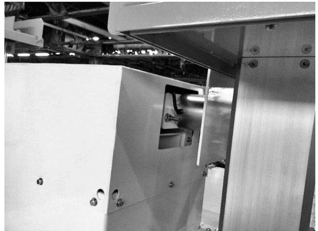
写真一3 カメラユニット05の振動防止
