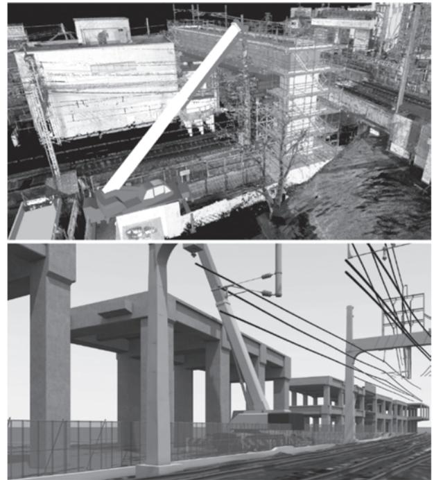
図-8 クレーン配置計画例
