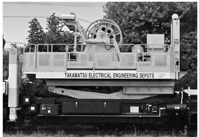
写真— 4 架線延線巻取装置, 搭載状態
