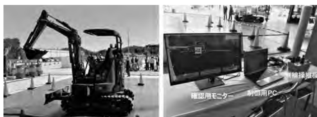
写真—2 使用した建設機械と操作システム
