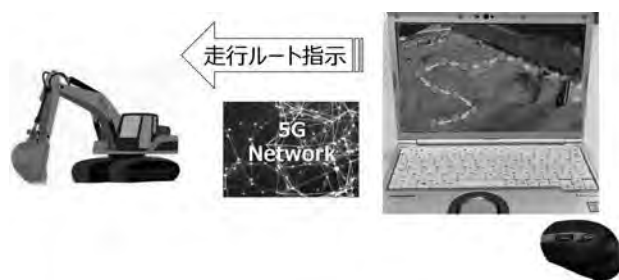
図—3 パソコンから建設機械の走行ルートを設定
