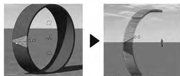
図一十 左：LOD 200 右：LOD 200 から自動生成した LOD 350 のモデル
