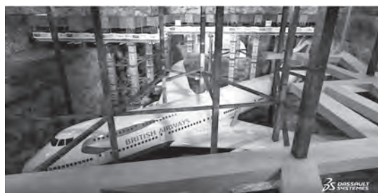
図—5 地下大空間を、既存施設を支えながら掘削する工事は一番の難関。各セクションをボールで支持しながら掘削を進める方法と手順の検討がBIM/CIMモデルで何種類か検討された
