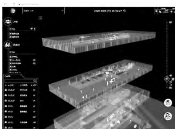
図—9 資機材位置モニタリングシステム (3DK-Field)
