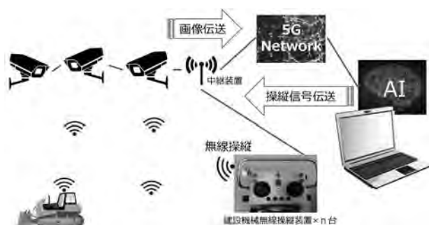
図一1 AIによる遠隔地からの建設機械操縦システム構成図
