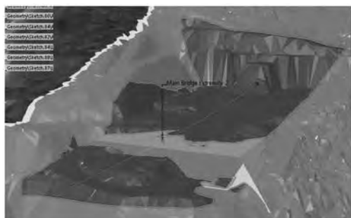
図一九 切土、盛土の形状、土量も表示可能
