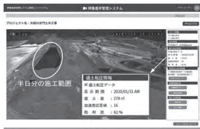
図—5 振動ローラのGNSSデータの重量表示
