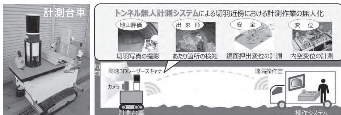
図—5 トンネル無人計測システム
