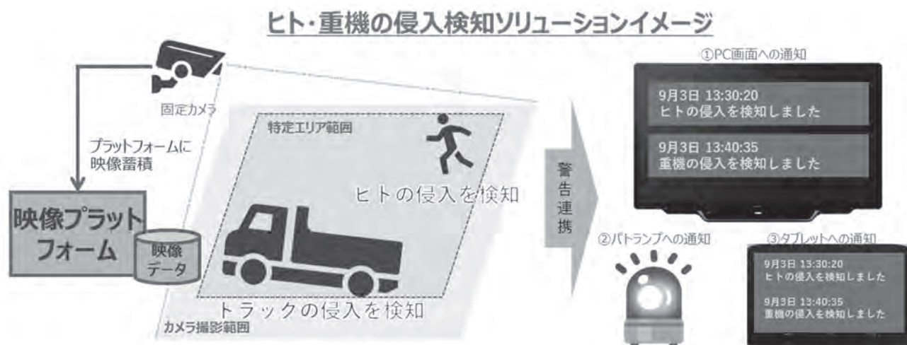
図-2 ヒト・重機の侵入検知ソリューション概要
