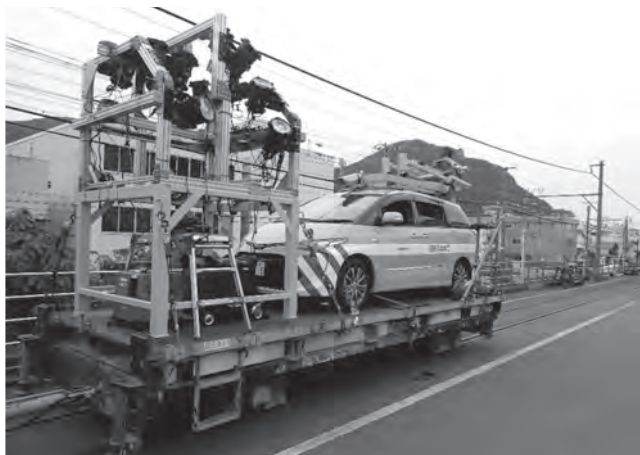
写真一3 トンネル点検用 MMS
