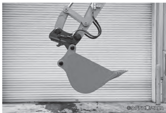
写真-3 タグチ工業 OC-122H ワンキャッチ 固定側フックロック機構
