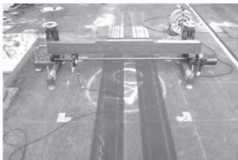
写真一 9 わだち掘れ量の計測状況
