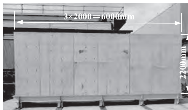
写真一 三 RC 壁試験体設置状況
