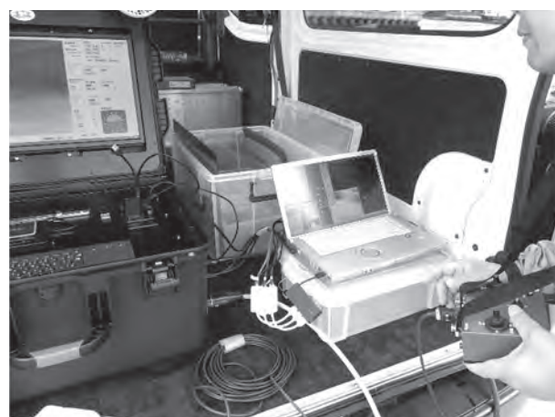
写真四 陸上からの ROV の操作状況
