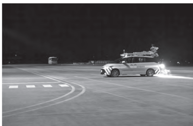
写真—2 空港滑走路における路面性状調査の状況
