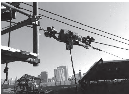
写真－15 水平に展開したアトラクション用ワイヤロープのカメラ点検状況
