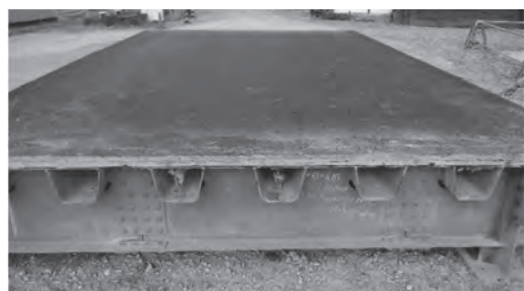
写真一 6 実物大の鋼床版試験体
