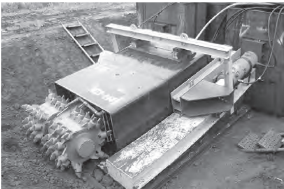
写真一 3 推進装置全景 (先端に汎用機のツインヘッド取付)
