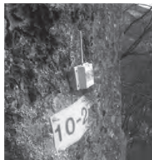
写真—2 IoT センサの整備例（上段：転石，下段：岩盤）
