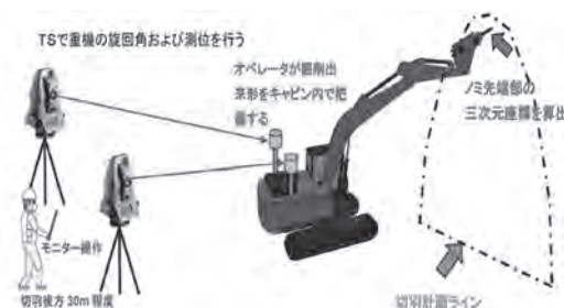
図-1 当たりガイダンスシステムの仕組み
