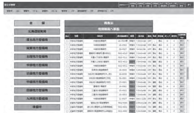
図-2 DSシステムの搭載一覧から表示車両を選択（地方整備局と事務所、建設機械番号、運転状態の表示）
