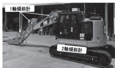
写真-2 油圧ブレイカー各部の傾斜計
