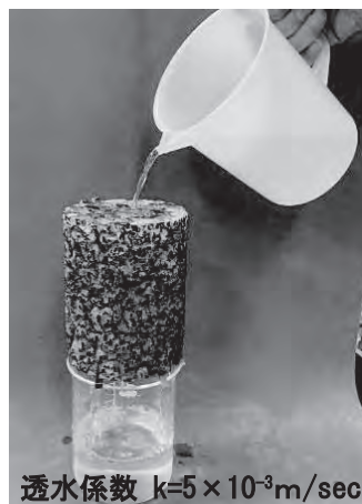
写真-1 透水性改良体
