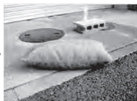
写真—5 落下試験 (5.5m)
