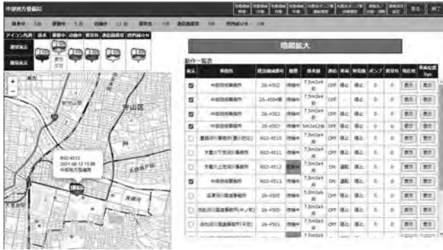
図-4 詳細地図と対象車両のアイコン表示 (位置情報と運転状態は定期的に自動更新)
