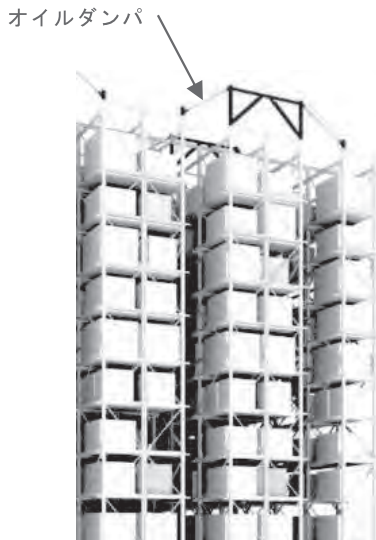
図-2 屋根裏空間を利用した制震構法
