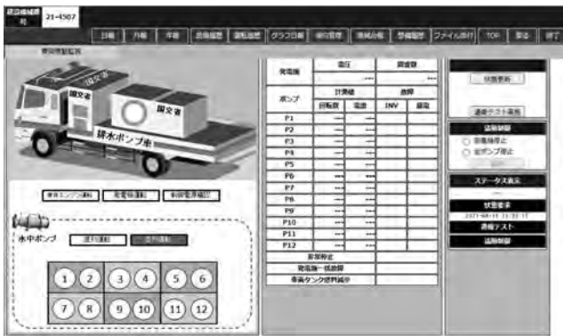
図-5 選択した車両の詳細表示の例 (排水ポンプは最大12台まで、状態表示と遠隔操作など)
