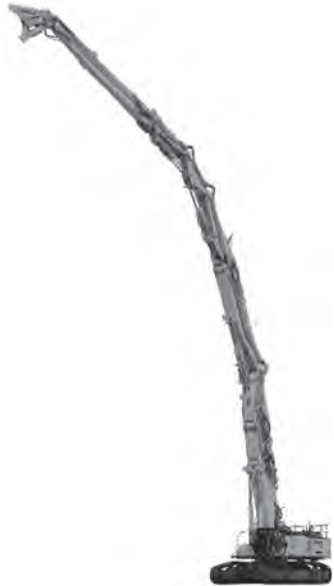
写真-2 コベルコ建機 SK1300DLC-10 4つ折れ超ロングアタッチメント仕様 (40m タイプ)
