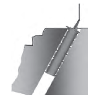
図-6 油圧式割岩装置挿入
