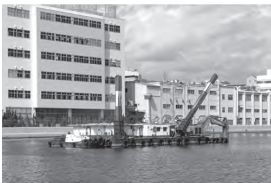
写真二 スパット格納機構付バックホウ台船
