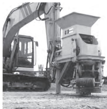
写真一2 標準施工システムの撒きだし機
