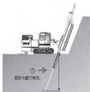
図-5 クローラドリルで削孔
