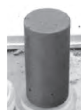
カルシア改質土（固化後）
