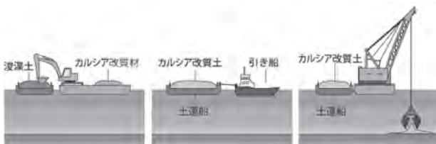
図-4 バックホウ混合とグラブ投入イメージ
