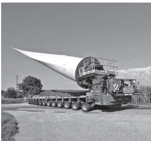
写真一6 ブレードを伏せることで上空の支障物を回避する
