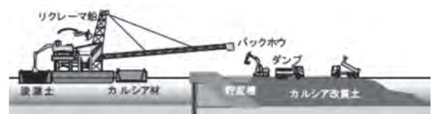
図-5 落下混合工法模式図
