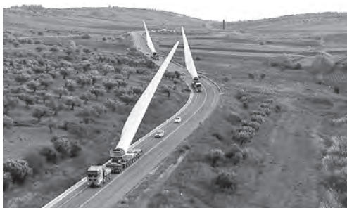
写真-2 トラクター+被けん引式モジュールトレーラー+起立装置での輸送例 (一貫輸送で使用可能な場合もある)
