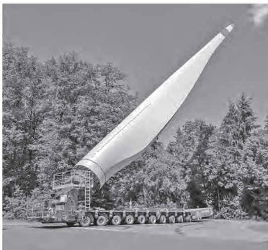
写真一5 ブレードを起立させることで平面上の全長を短縮する
