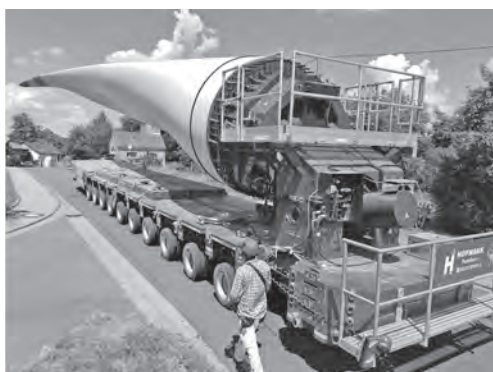
写真-1 自走式台車+起立装置での輸送例
