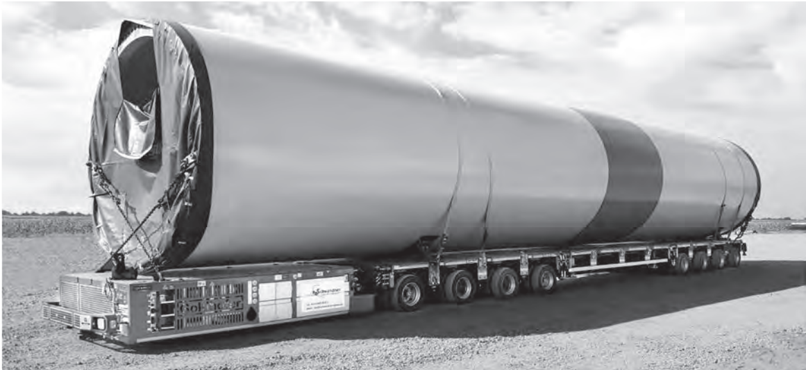
写真一七 タワーセグメントの輸送例
