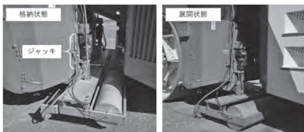
図-10 本システム昇降装置
