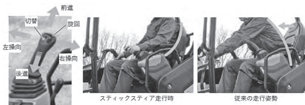
図一 3 スティックステアコントロール
