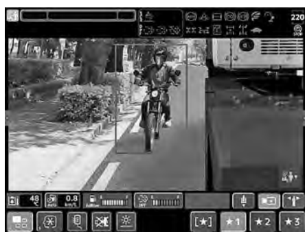
写真—4 人物検知警報装置
