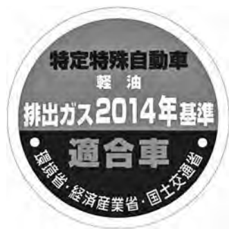
図一六 特定特殊自動車排出ガス2014年基準適合銘板
