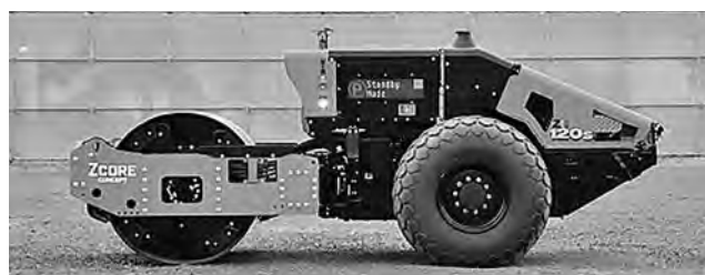
写真-1 振動ローラ自律運転システム搭載機 (コンセプトマシン)
