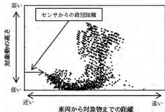
図—3 作業着と湯気の両方を検知したデータ
