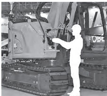
写真-3 尿素水の給水
