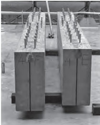
写真一五 防水テープによる止水処理
