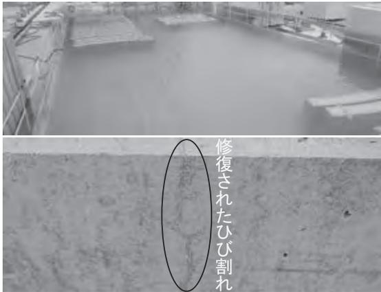
写真一4 ひび割れ自己治癒日本での実証実験
