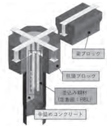
図-3 本工法における杭頭接合構造
