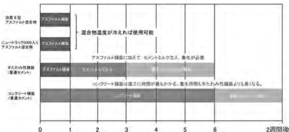
図一3 舗装種類別の施工期間（施工面積 2,000m<sup>2</sup> の一例）
