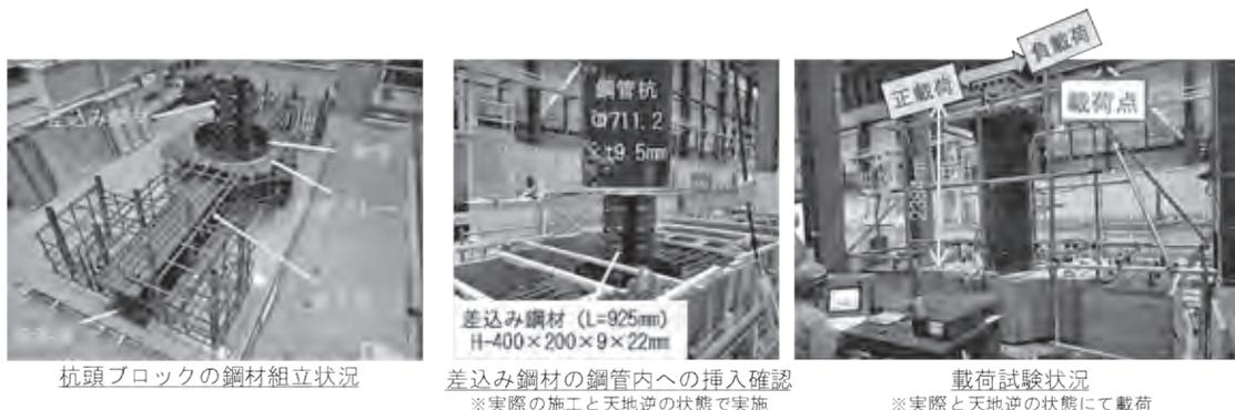
図-10 試験体の製作および載荷試験状況
