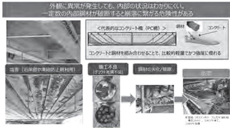
図-2 コンクリート橋梁の劣化要因
