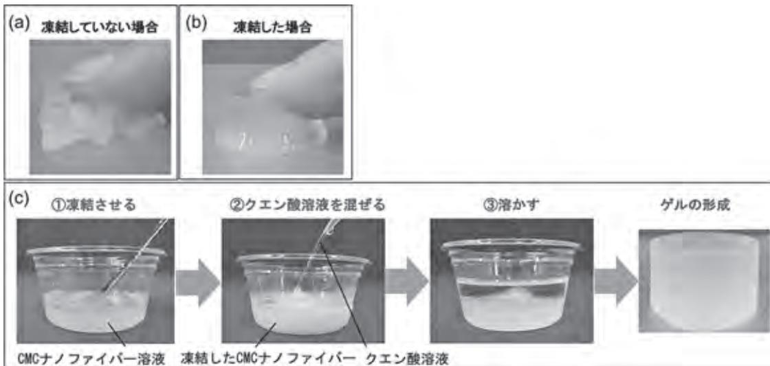
図-3 凍結架橋 CMC ナノファイバーゲルの作製
