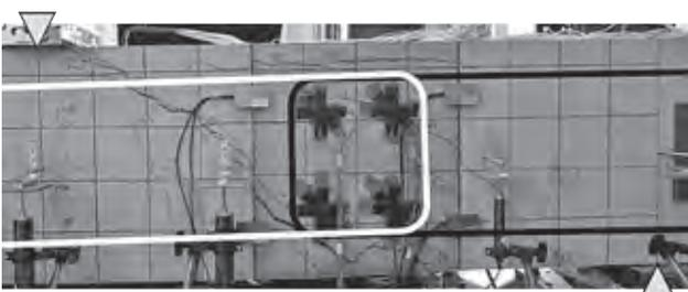
写真一 四 せん断破壊状況
