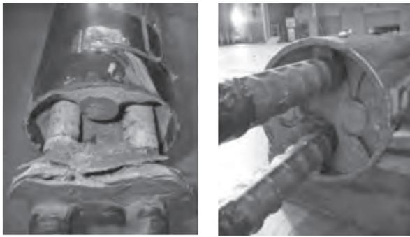
(a) ねじ節鉄筋 (b) たけ節鉄筋
