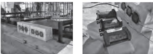
写真二2 部材同一温度養生状況
