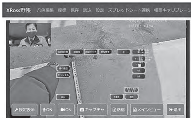
図一六 デジタルメジャーによる計測
