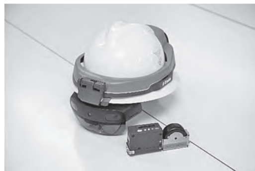
写真-2 使用機器(現場デバイス) Trimble XR10 (HoloLens 2) とデジタルメジャー
