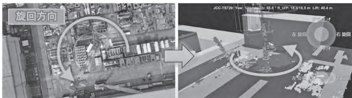
図一3 3D-LiDARによる点群データ取得
