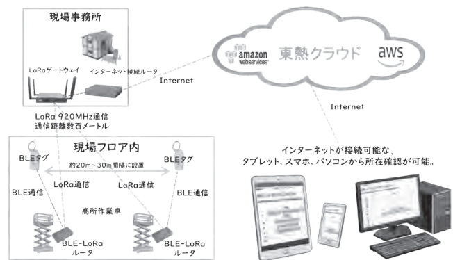
図-2 作業車管理システムのハードウェア構成
