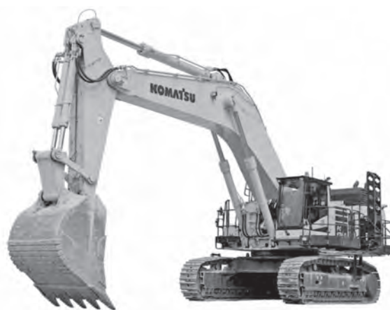
写真一 3 コマツ大型油圧ショベル [PC1250-11R]
