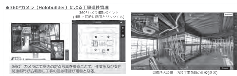
図-18 BIM データとリンクしたデジタルツールの活用事例 (プロジェクト B)
