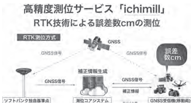
図-1 RTK 技術を用いた高精度測位
