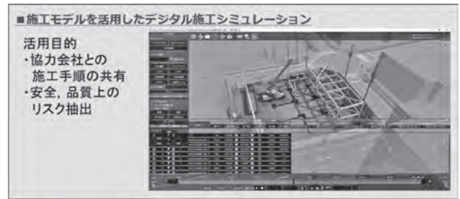
図—15 施工計画での活用事例 (プロジェクト B)
