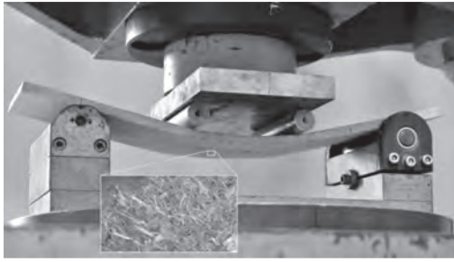
写真-3 ラクツムのたわみ硬化挙動
