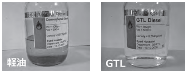
図一3 4年間保存したサンプルの比較（軽油では瓶の底にスラッジが沈殿している）
