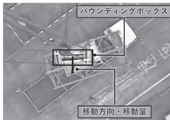
図一5 物体検知技術による荷振れ検知
