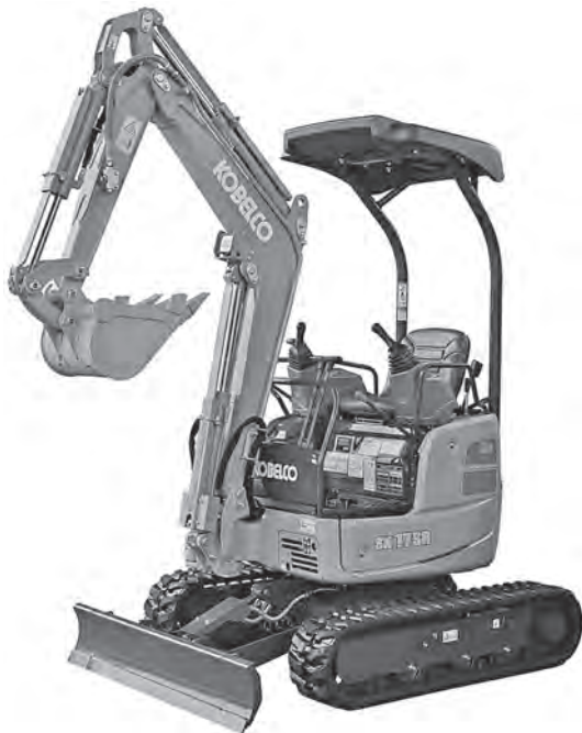
写真—3 コベルコ建機 SK17SR-6 ミニショベル（後方超小旋回型）
