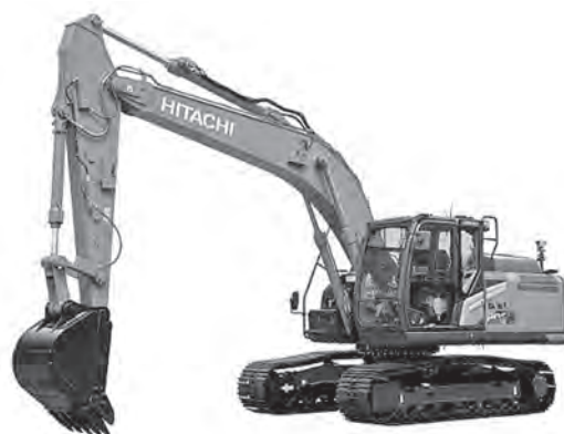
写真一 日立建機 ZX200X-7 情報化施工油圧ショベル
