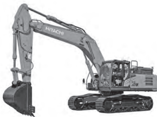
写真二 日立建機 ZX330X-7 情報化施工油圧ショベル
