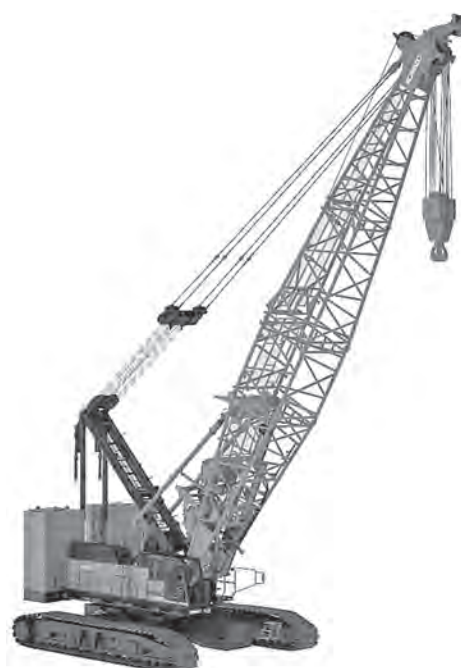
写真-5 コベルコ建機 Mastertech7200G NEO クローラクレーン
