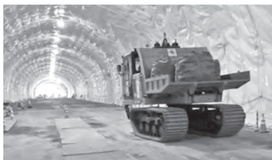
写真—2 坑内を走行する無人クローラダンプ
