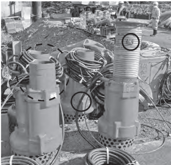
写真—6 吐出し口（左点線内）とホース貫通型フランジのホース貫通固定部（右〇）
