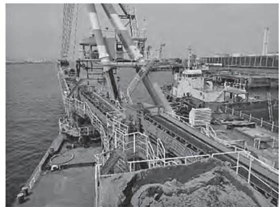
写真一 3 落下混合用コンベア (No.1, No.2)
