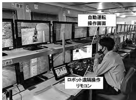
写真-6 操作室状況
