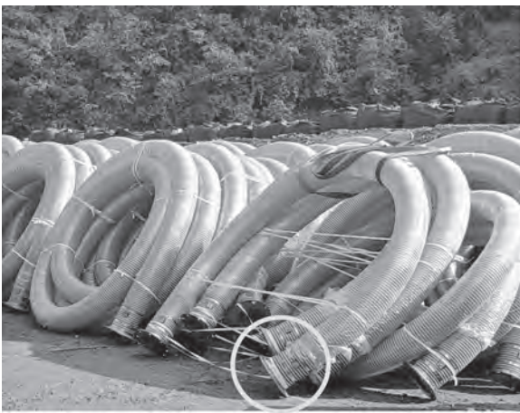
写真－3 ホース1本が長く連結部は気密で堅固
