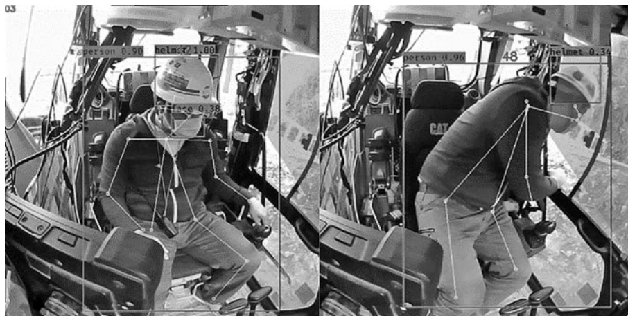
図-4 建設機械の扉・窓からの身の乗出し行為検知 (左: 正常, 右: 不安全行動)
