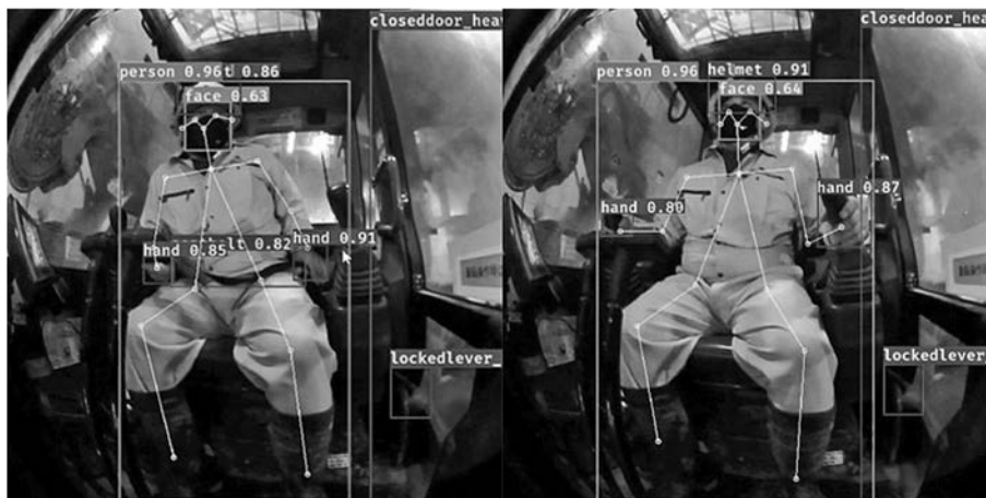
図—5 シートベルトの着用状況検知（左：正常，右：不安全行動）
