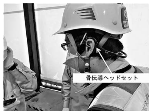
図-7 骨伝導ヘッドセットの装着状況
