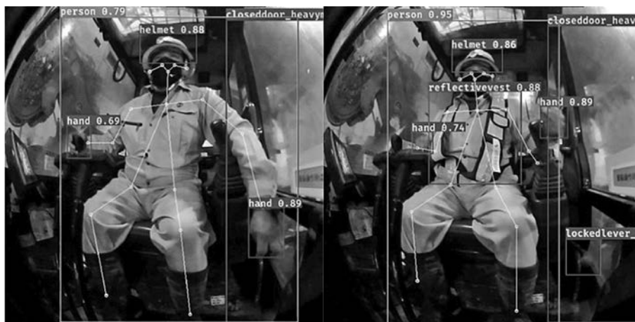
図—6 安全ベストの着用状況検知（左：正常，右：不安全行動）
