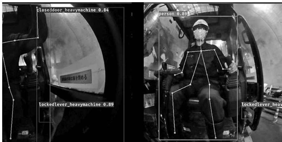
図—7 建設機械の扉の開閉状況検知（左：閉じた状況のドアの検知）
