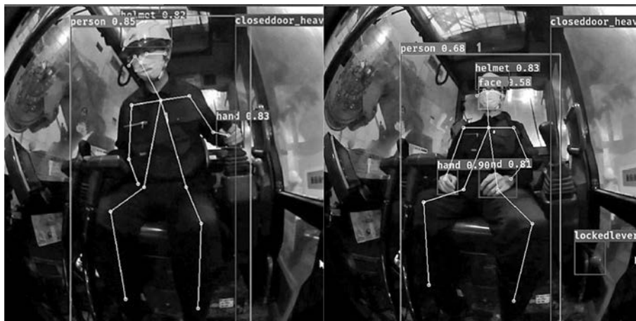
図一8 オペレータの休憩状況検知（左：正常、右：不安全行動）
