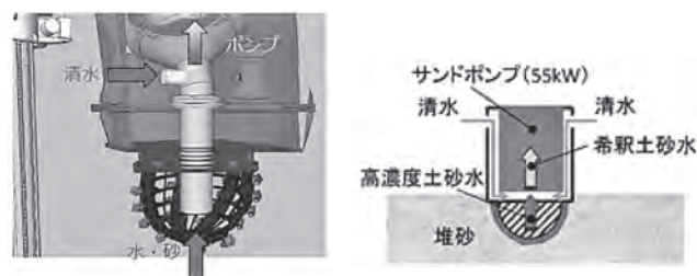
図—7 二重管による清水吸引機構
