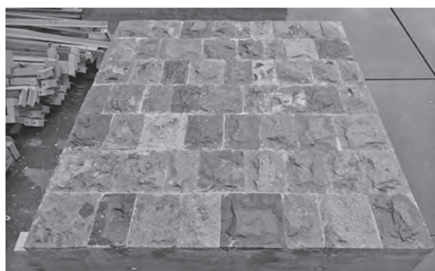
写真一7 再利用石材ブロック
