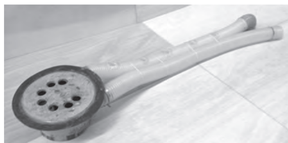
写真—1 排砂管（裏返した状況）
