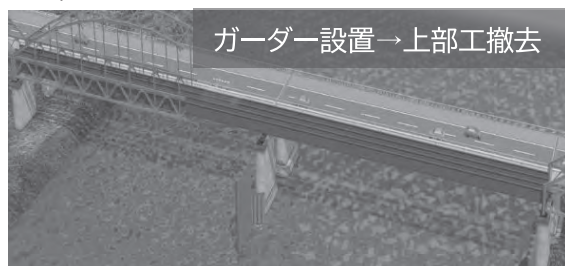
Step3: ガーダーをガーダー用下部工へ横取
