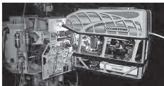
写真-6 作業用 ROV 作業イメージ 10)
