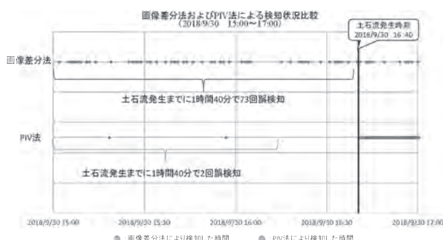
図ー7 画像差分法と PIV 手法の検知状況の比較結果
