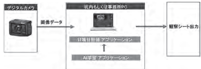
図—5 画像による評価システムの構成
