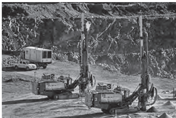
写真-3 白いトレーラーに搭載されたベンチリモートから複数台のせん孔機の実際の操作
