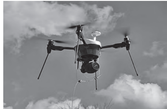
写真—4 有線給電映像伝送ドローン
