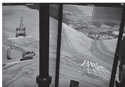
2種類のAR映像（左：現況地盤・機械姿勢、右：3次元設計データ）
