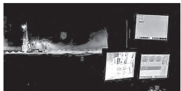
写真-5 夜間でのベンチリモートでのせん孔風景
