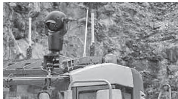
写真—8 ベンチリモートから制御されるロッドハンドリング、ロックドリル／口元／を撮影するカメラ
