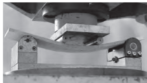
図—3 高靱性化による曲げ強度 14 MPaの実現
