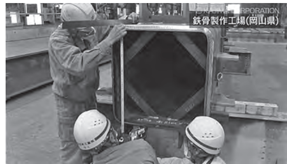
写真一九 遠隔製品検査実施状況
