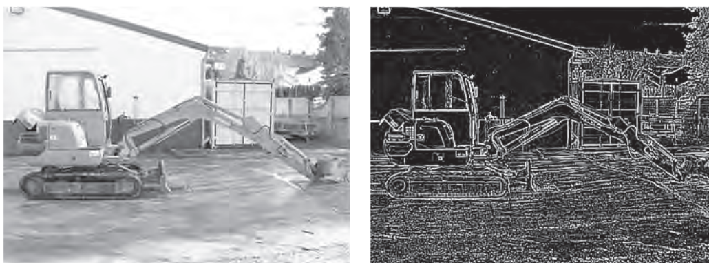
図-2 ラプラシアンフィルタ適用によるエッジ検出の例 (左：検出前、右：検出後)
