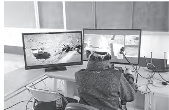
写真—5 遠隔操作の様子／左が有線ドローンからの映像(出所:アクティオ)
