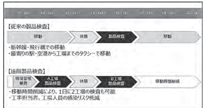
図一六 遠隔製品検査システム概要図
