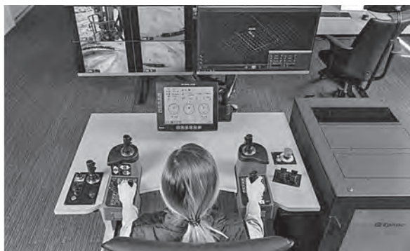
写真—9 現場事務所に設置されたオフィステレリモートの操作作業デスク
