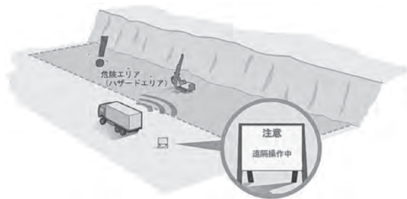
図-1 遠隔操作による危険エリアでのせん孔作業
