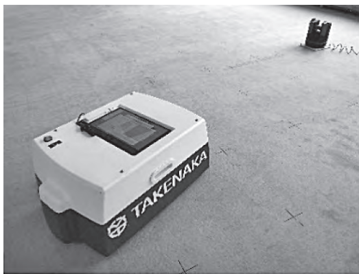
写真-1 墨出しロボットシステムの構成
