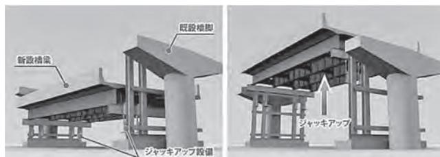
図一 ジャッキアップ架設工法の概要
