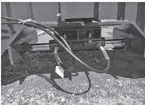
写真一八 吊り天秤に設けた傾き調整ジャッキ
