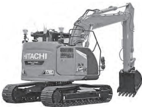
写真一 4 日立建機 ZX135USX-7 情報化施工油圧ショベル
