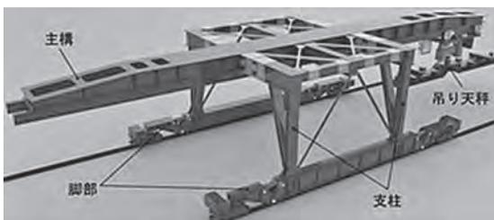
写真二 本取替機構造
