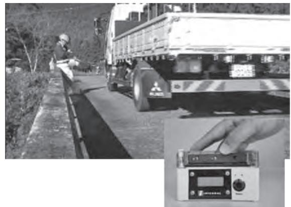
写真一八 加速度計を用いた橋梁のたわみ計測の様子
