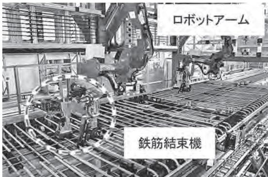
写真一8 鉄筋結束状況
