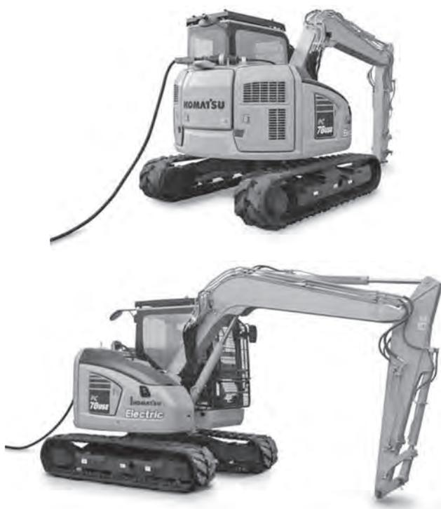
写真—3 有線式電動油圧ショベル「PC78USE-11」
