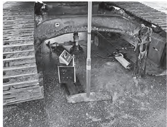
写真一 7 平板載荷試験状況
