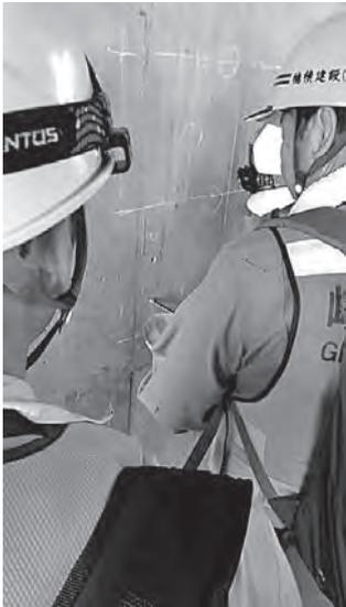
写真一五 コンクリート橋脚の中性化試験の様子
