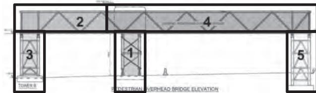
図一6 当初計画施工 ステップ図
