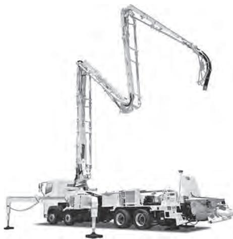
写真一 5 極東開発工業 PY140-36A コンクリートポンプ
