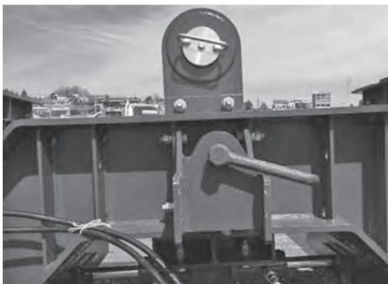
写真一七 吊り天秤のスライド可能な吊りピース
