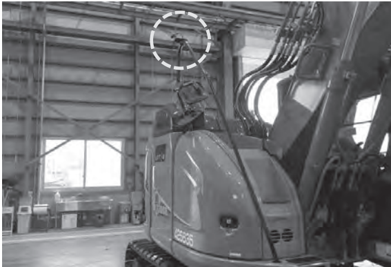
写真-3 カメラの固定方法 (右側面)
