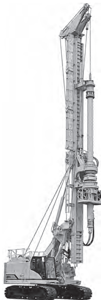
写真-1 住友重機械建機クレーン SDX407-2 リーダ式アースドリル
