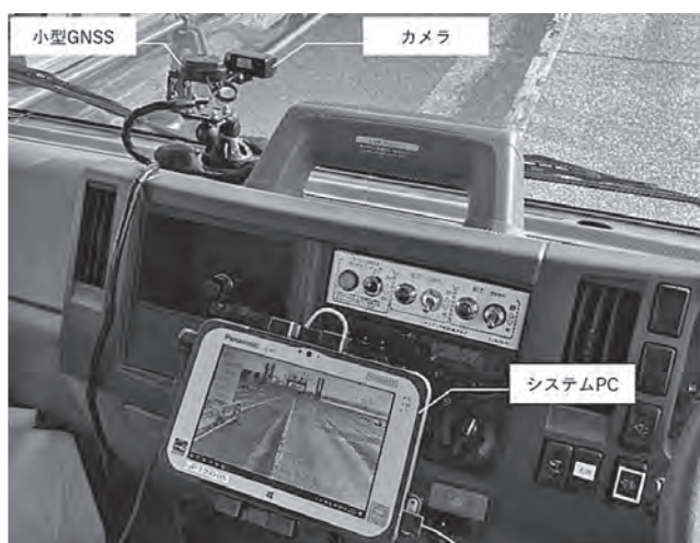
図一10 車内機器搭載状況
