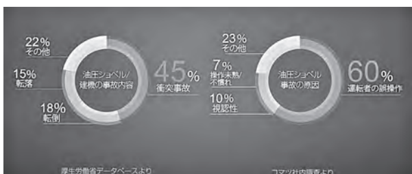
図-2 油圧ショベル・建機の事故内容と事故の原因
