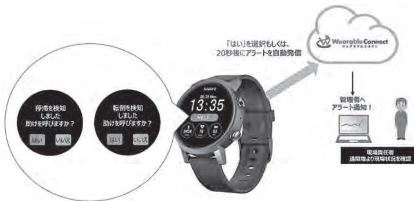
図一6 転倒・停滞アラートの発信キャンセル
