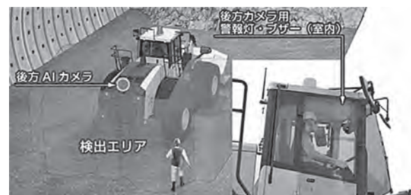
図-7 AI 搭載人検知カメラ
