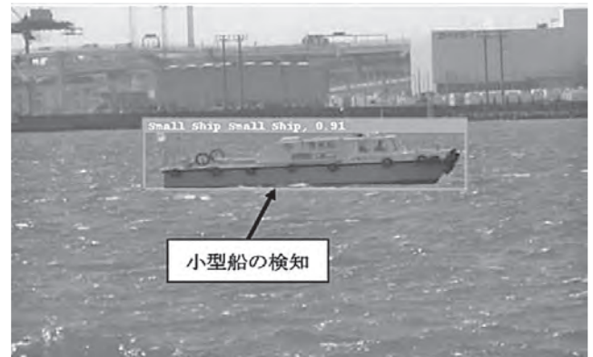
図一17 小型船の検知状況
