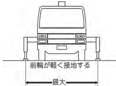
図-18 アウトリガー設置時の前輪接地
