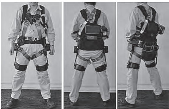
写真一7 安全帯と腰道具を併用した様子
