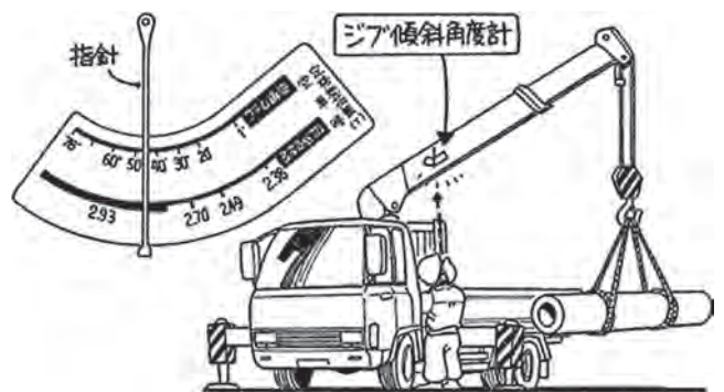
図-9 ジブ傾斜角度計（荷重指示計）
