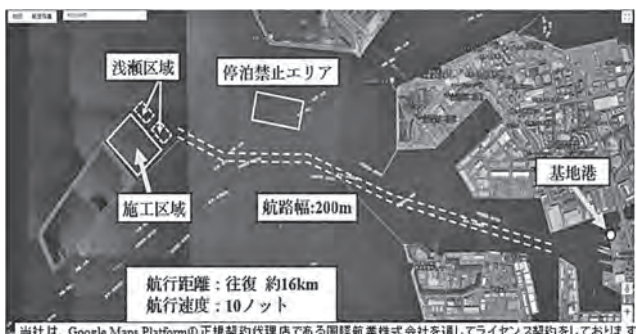
図一六 施工場所及び航行経路
