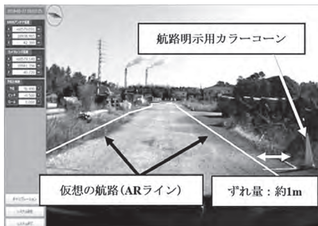
図一4 ARライン描画状況 (D-GNSS方位計使用)
