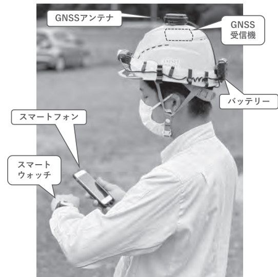
図—9 RTK-GNSSの装備
