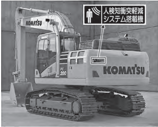
図一4 人検知システム搭載機外観（デカールが追加される）
