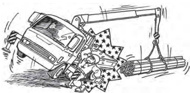
図-11 積載形トラッククレーンの転倒事故
