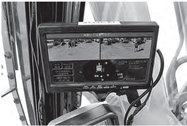
写真一2 運転室内モニター
