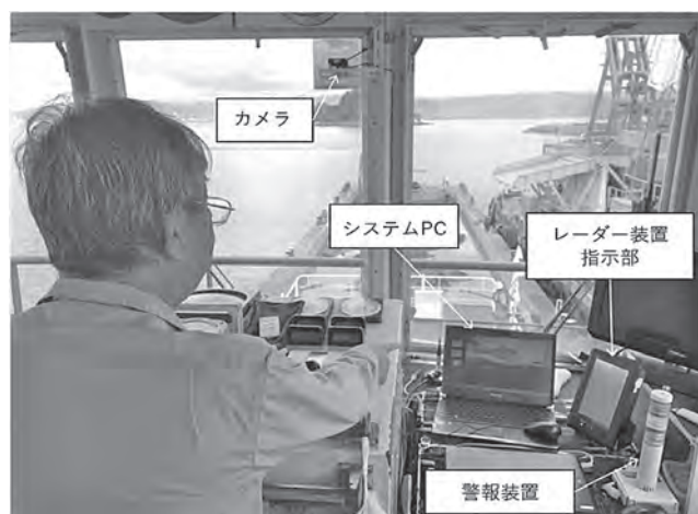
図一13 機器設置状況 (屋内)
