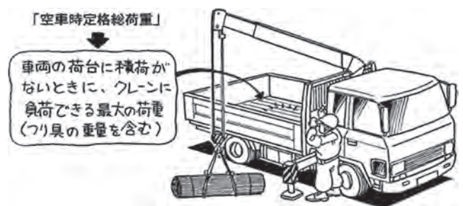
図—15 空車時定格総荷重
