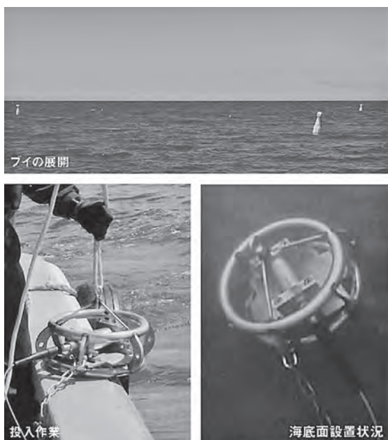
写真一三 海底微動アレイ探査の作業状況 3)
