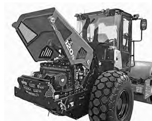
写真-3 エンジンカバーを開けた際のイメージ
