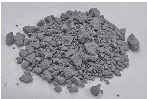
写真-4 炭酸カルシウムと細骨材の混合物
