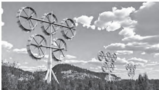
図—4 200kWレンズ×5基のMW級風車 (CG)
