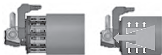
図一1 杭専用吊り具の稼働原理 (1)
