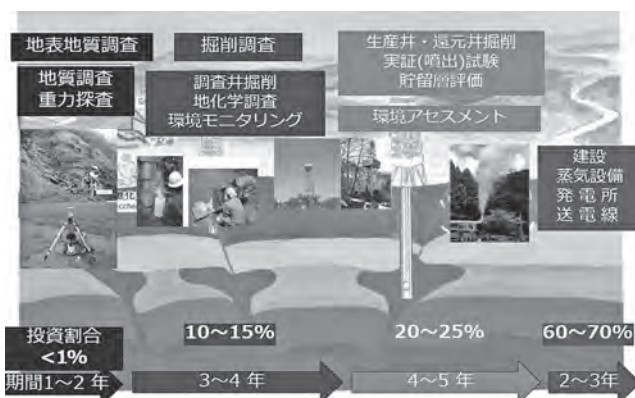
図-6 地熱開発の調査から開発までのフロー(概念図)
