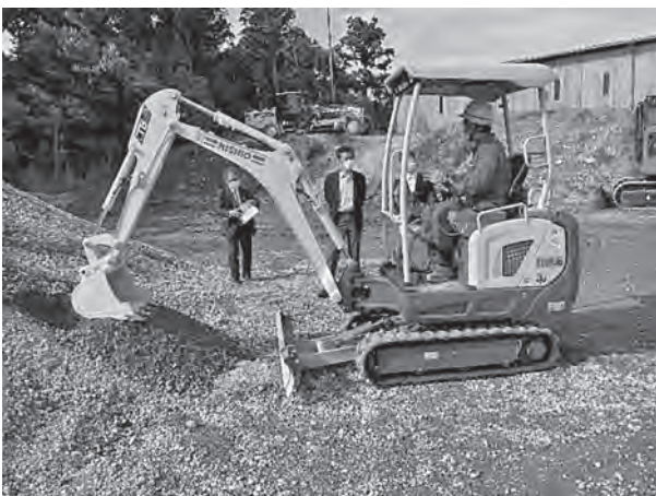
写真-6 竹内製作所製電動バックホウ
