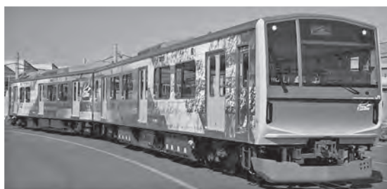
写真—5 水素ハイブリッド電車 HYBARI
