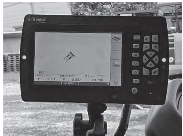
写真-3 Trimble3D コントロールの画面
