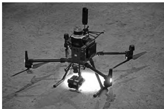
写真 1 トンネル坑内自律飛行ドローン
