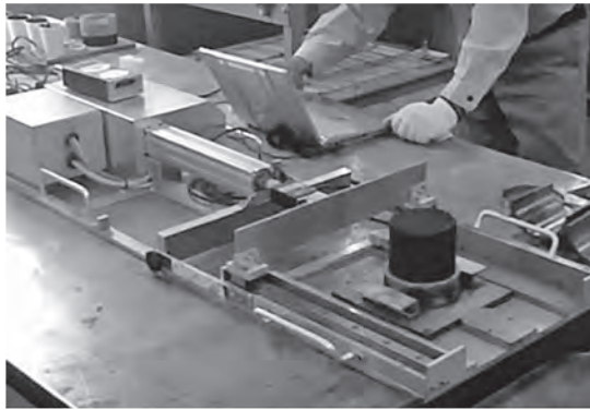
写真一5 レーキ負荷試験
