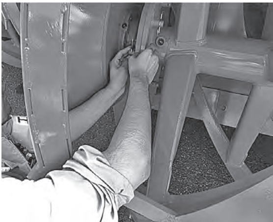
図-4 シャーピン交換作業
