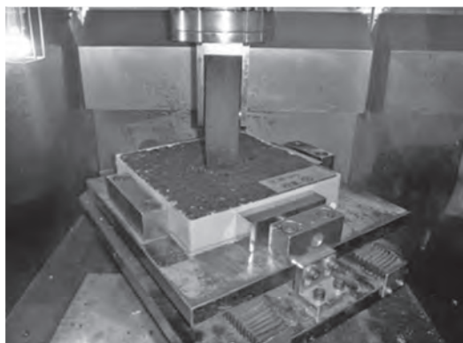
写真一 2 繰り返し表面剥奪試験
