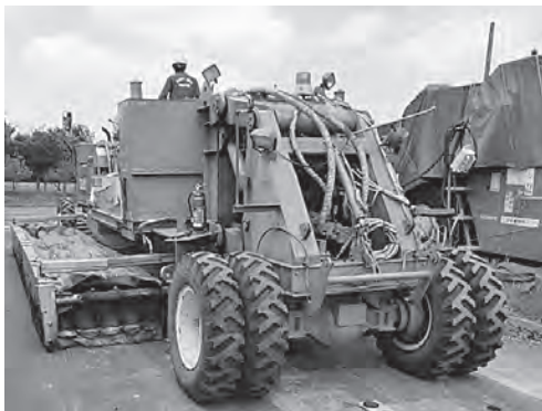
写真-1 熱風循環式路面ヒータ車
