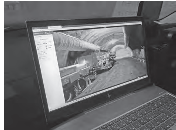
写真-4 遠隔臨場ドローンシステムによる坑内映像のリアルタイム確認
