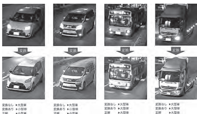
図-3 AIによる夜間映像から昼間映像への変換結果の例
