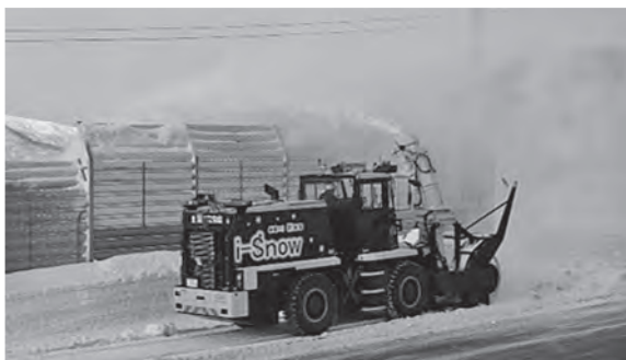
写真-3 道路附属物等の障害物を避けた自動投雪(狩勝峠)
