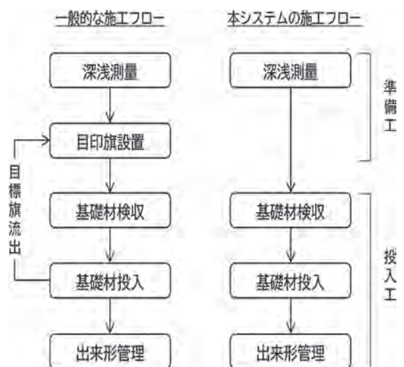
図-10 施工フロー
