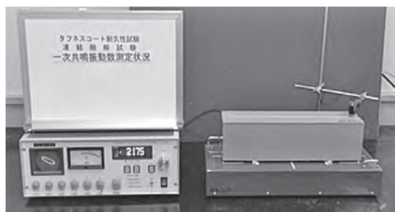
写真—8 相対動弾性係数の計測状況
