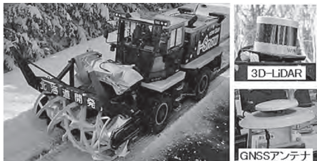
写真一 1 i-Snow 仕様ロータリ除雪車の外観と設置機器
