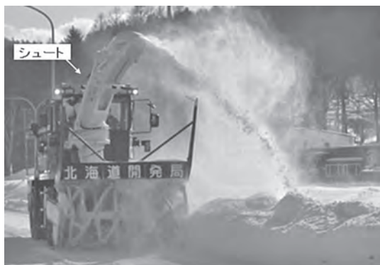
写真一4 投雪作業実験状況
