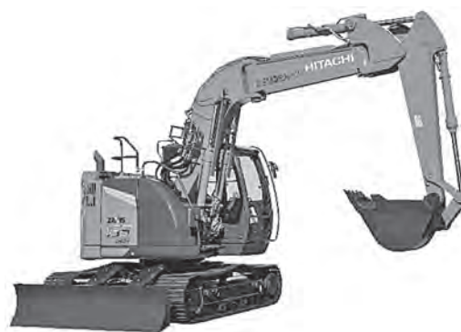
写真-1 日立建機 ZX135USOS-7 油圧ショベル
