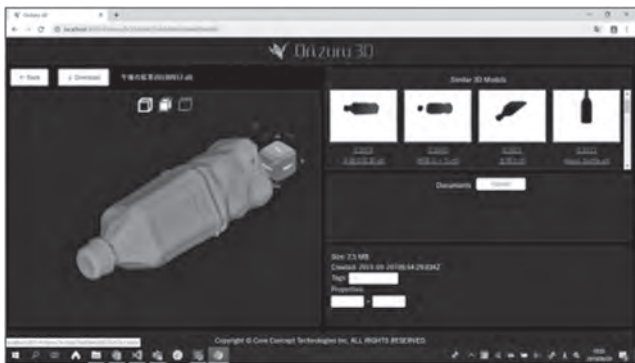
図-4 左側は3Dスキャナーで取ったあるパーツの点群データ/右側は点群データからAIが形状認識し、似たパーツをビッグデータから検出し形状の類似度の高い物から並べたもの
