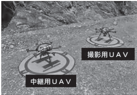
図-5 撮影用 UAV と中継用 UAV
