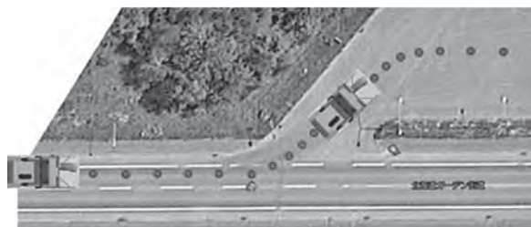
図一7 磁気マーカ埋設位置
