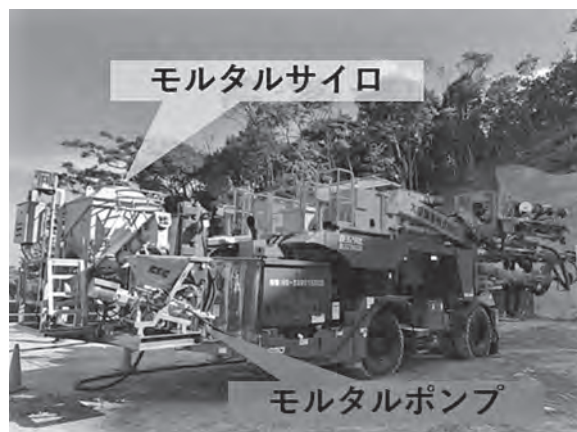
図-11 モルタル供給装置の一体化
