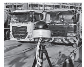
写真-1 ネットワークカメラによる打設開始・終了時刻の認識
