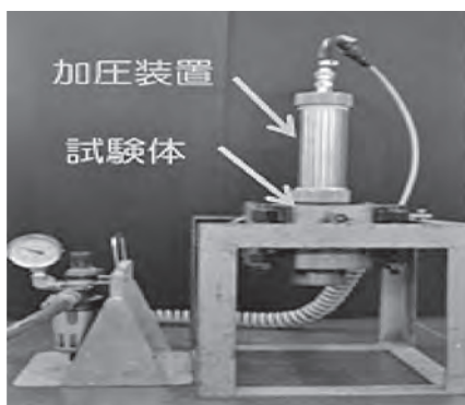
写真-5 防水性確認実験
