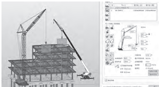
図-6 本件ソフトウェアの吊荷選択状態
