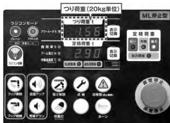
図-2 新型 集中コントロールパネル
