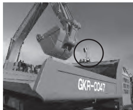
写真一三 LiDAR と RFID 受信器のダンプ実装事例
