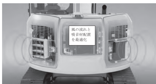
図—8 外装構造変更による騒音低減
