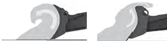
図-10 ブレード形状変更の概念図
