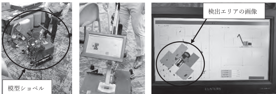
写真-5 模型ショベルによる周囲衝突軽減システムのデモ風景
