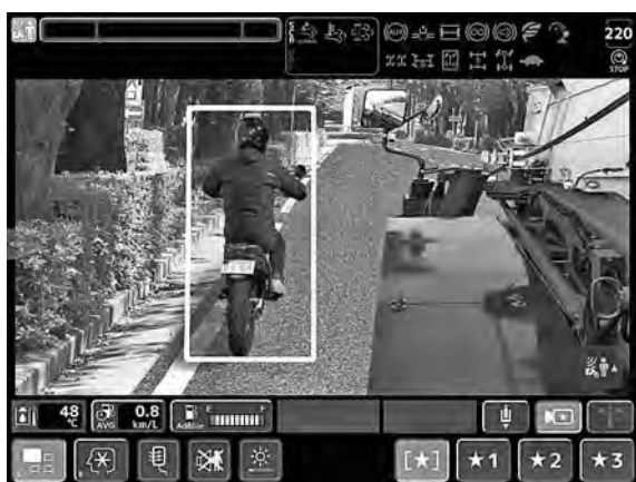
写真—5 人物検知警報装置
