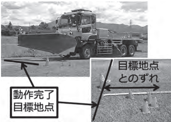
写真-4 自動制御動作精度の確認状況
