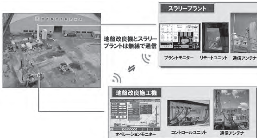
図一 自動打設システム概要
