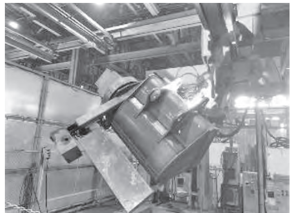
写真三 バケットのロボット溶接
