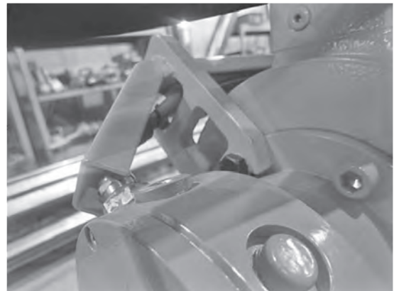
写真二 ロールオーバーセンサの補強
