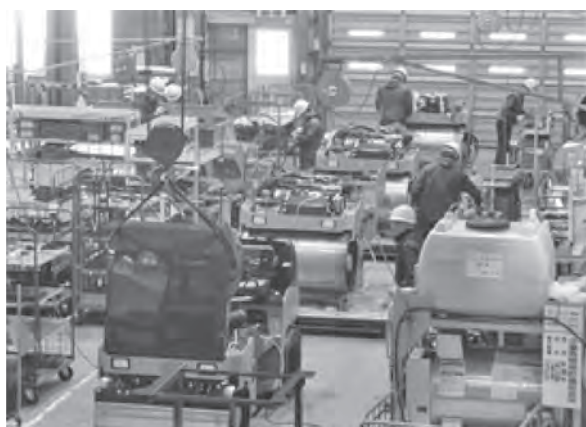
写真-5 締固め機械の生産ライン
