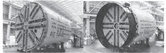
写真-2 MSD工法用シールドマシン(受入側/押出側)
