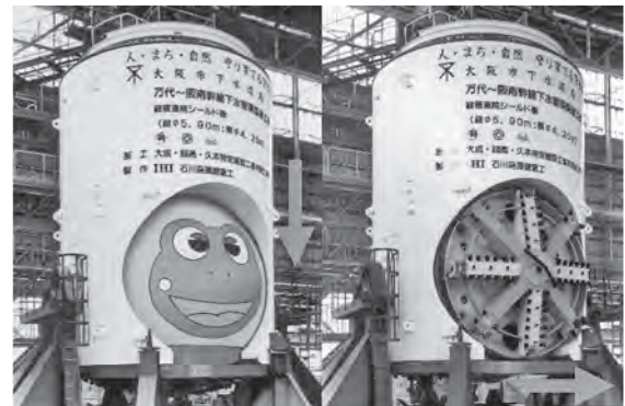
写真-7 球体シールド（ホルン工法：縦横連続掘進機）
