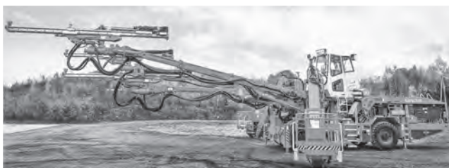
写真一 コンピュータジャンボ（SANDVIK社製）
