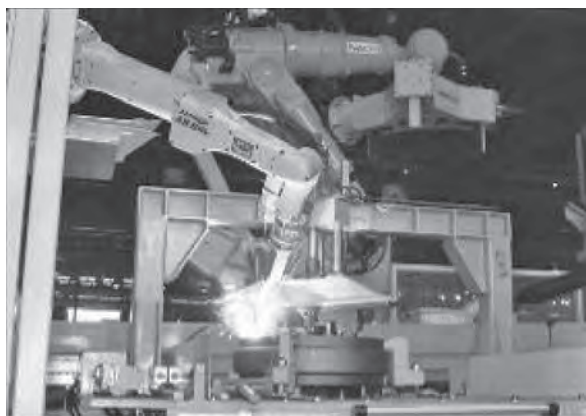
写真-4 フロントアイドラの自動ライン
