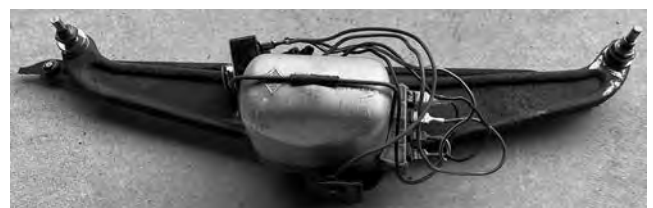
写真一3 ワイパーリンク
