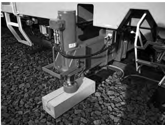
写真-3 脱線復旧装置
