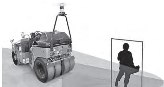
写真—5 「衝突被害軽減アシスト装置」作動時イメージ
