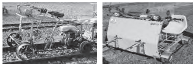
写真-1 足漕ぎ式点検カート 写真-2 ガソリンエンジン式点検カート
