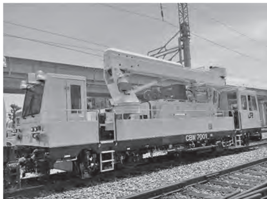
写真—2 電柱用高所作業車
