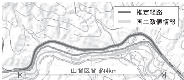
図一4 自己位置推定による経路推定
