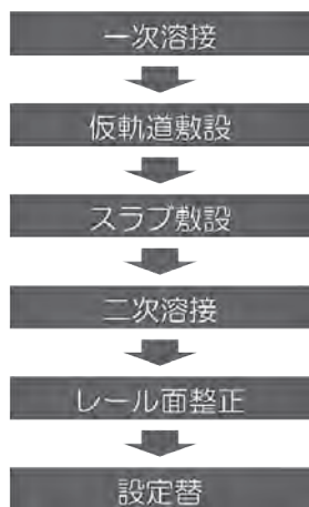
図1 スラブ軌道敷設工事の流れ
