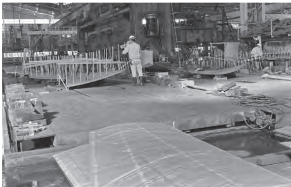
写真—5 成形されたブロック外板（手前）
