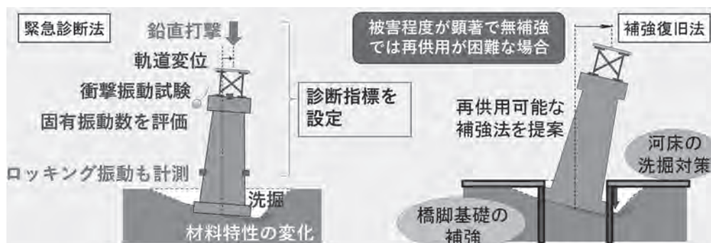
図—3 緊急診断法と補強復旧法
