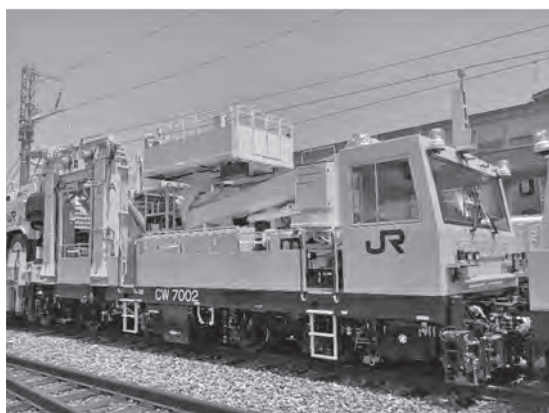
写真—3 装柱作業車
