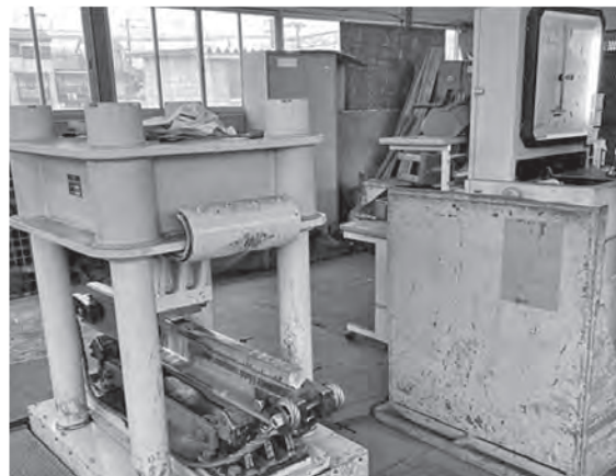
写真—6 レール破断試験
