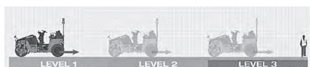
写真—6 「衝突被害軽減アシスト装置」制御イメージ
