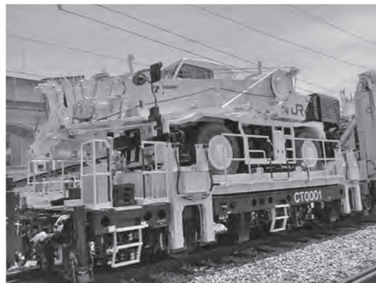
写真—4 電柱建植車
