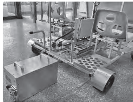
写真—5 バッテリー脱装状況
