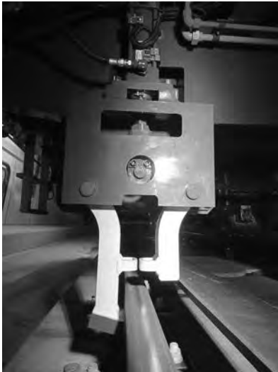
写真—10 レールキャッチ
