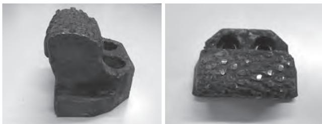
写真-6 摩耗した切削ビット
