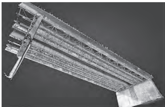
図一2 橋梁上下面をレーザースキャナにて計測
