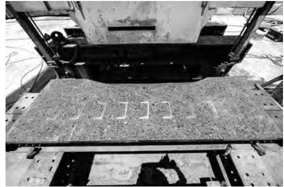
写真一4 切り下げ切断箇所 断面状況
