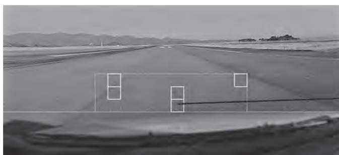
写真－3 滑走路画像データの認証例（□枠がき裂・損傷の検知箇所）
