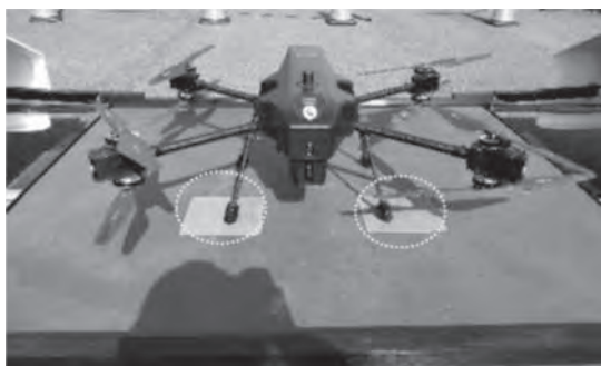
写真-1 ドローン基地充電部
