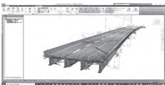
図一 17 既設橋梁計測点群データ
