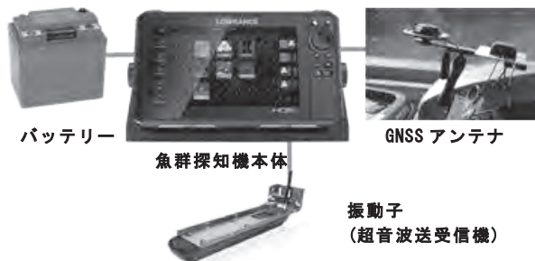
図-2 ソナーマッピング計測システム・機器構成
