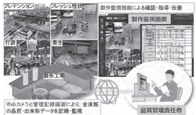
図一4 床版製作工場の監視システム
