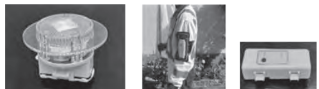
図一12 専用自発光デリネーター & 受信機
