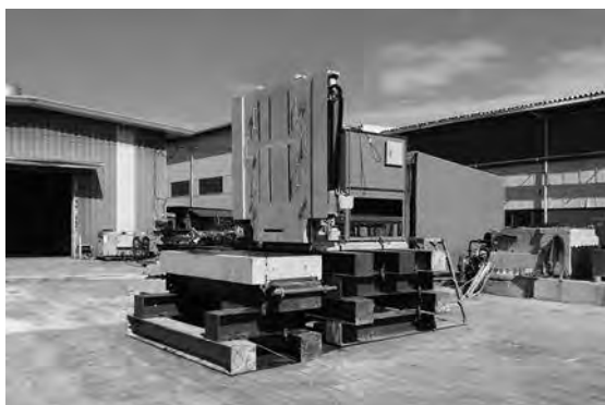
写真-1 基礎躯体クールカット装置
