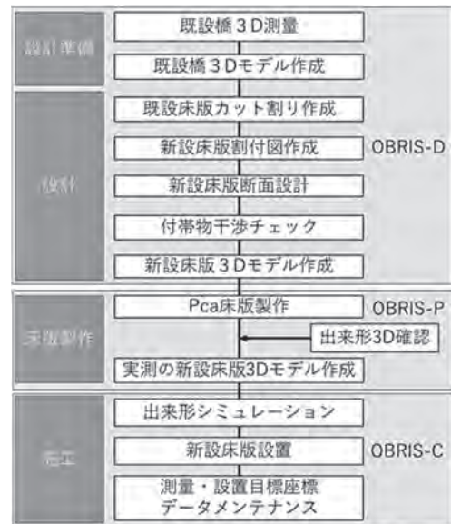
図一 23 OBRIS を用いた業務フロー遷移図
