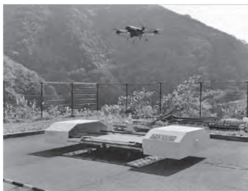
写真一五 ドローン基地からの操作・補助員なし離陸状況
