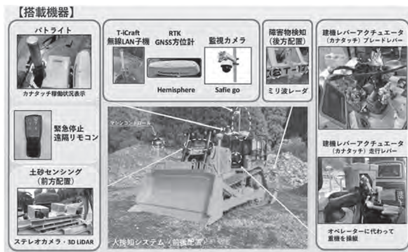
図一6 自動化ブルドーザ:(CAT D8 32t級 カナタッチ仕様)
