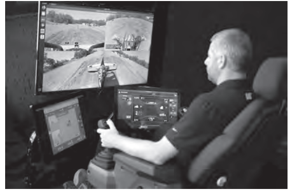
写真一 4 オペレータステーションシステム
