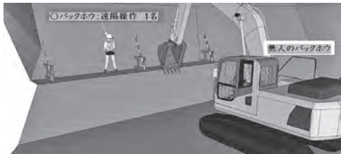
【リスク 4】 遠隔 + 丁張で掘削 危険区域に常時 1 名
