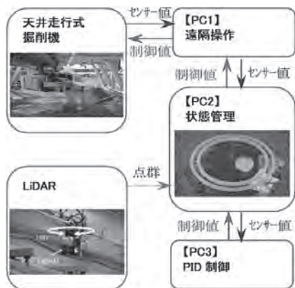
図-1 自動掘削システムの構成
