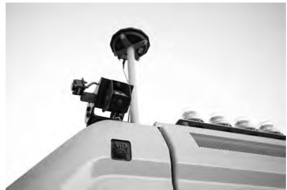
写真—1 カメラと4色のインジケータランプ
