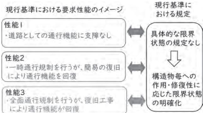
図-6 要求性能と現行技術基準の規定
