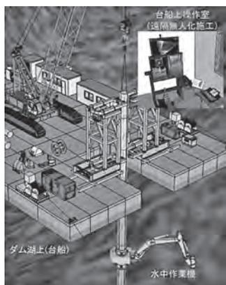
図-1 T-iROBO UW による作業状況
