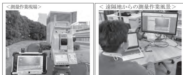
写真-5 イメージング TS Leica MS60 とフィールド・コントローラー CS30
