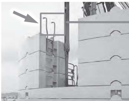
写真-14 カウンタウエイト昇降用ラダー
