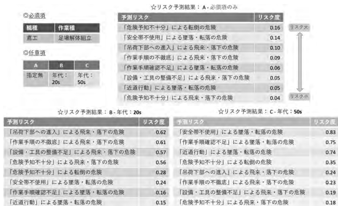
図—6 ダイナミック・チェックリストの導出例
