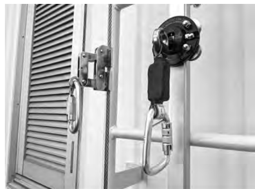
写真六 ストッパー機能を有した垂直設置型システム専用金具
