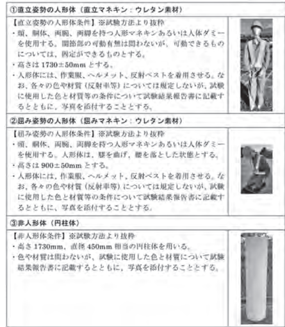
図一5 現場実証試験に使用した被検体
