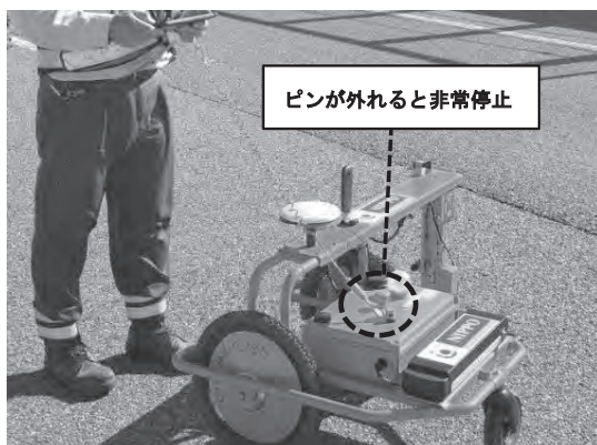
写真一七 ピンが外れると非常停止する安全装置
