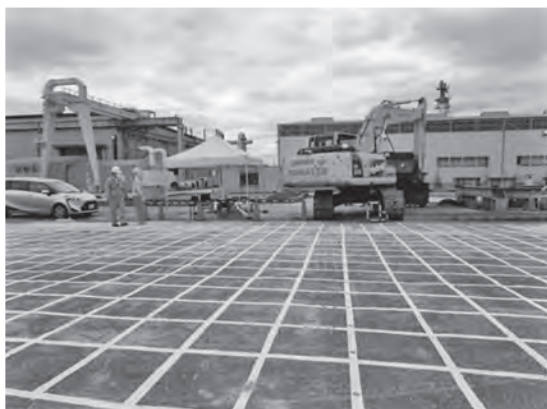
図一 4 検知領域試験の実施状況
