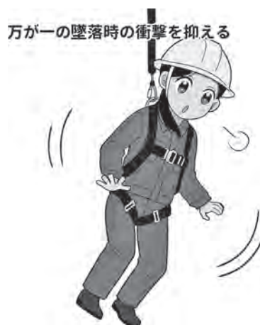
図-1 墜落・転落を制止し地面への衝突を防ぐ「フォールアレスト」
