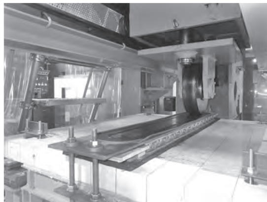
写真—1 小型輪荷重走行試験機
