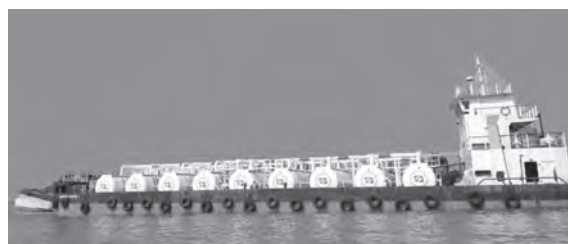
写真一 3 艀装セメント供給船
