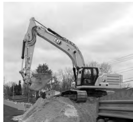
写真—1 Cat 336/340 油圧ショベル
