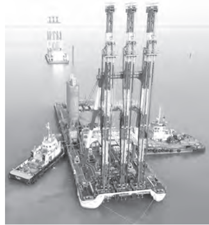
写真-2 艀装 CDM 船 (FTTN1 2軸×3連装)
