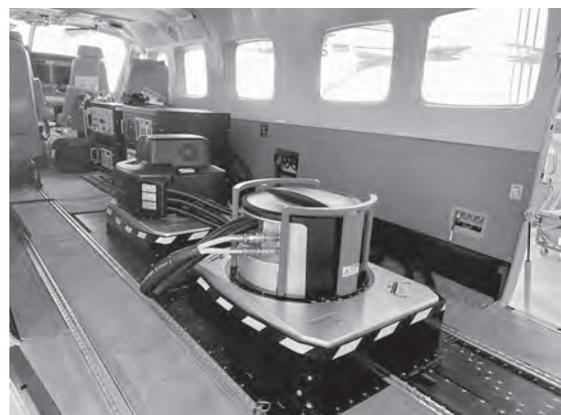
写真-2 固定翼に搭載されたALBセンサ
