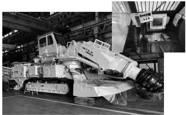
写真—3 ロードヘッダ (SLB-300SG III 型)
