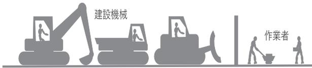
図-6 建設機械と作業者を独立させた施工環境
