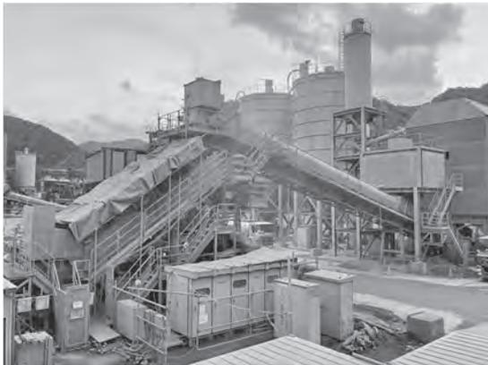
写真—6 CSG 製造設備
